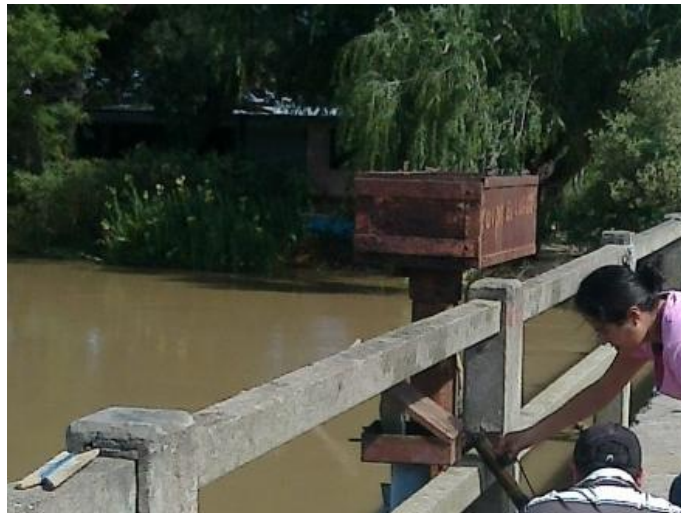
Figura 2.26 Caja de un limnómetro ya en desuso todo herrumbrado producto del severo clima
