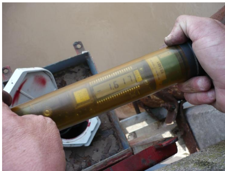
Figura 2.9 Visor electrónico del nivel con el Datalogger y conexión inalámbrica para notebook
