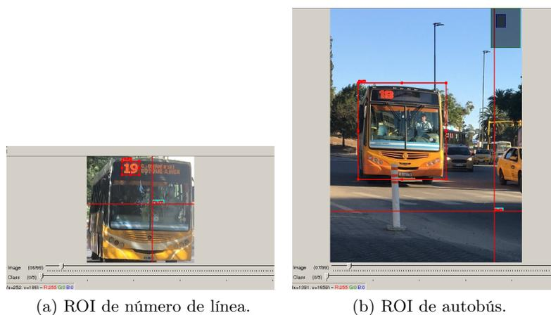
Figura 5.2: Generación de anotaciones mediante *OpenLabeling*.
