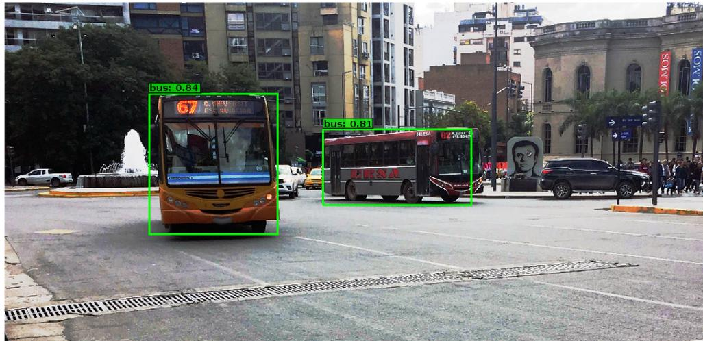
Figura 2.19: Múltiples detecciones de objeto ‘AUTOBUS’, mediante la ejecución de modelo YOLO v2.
