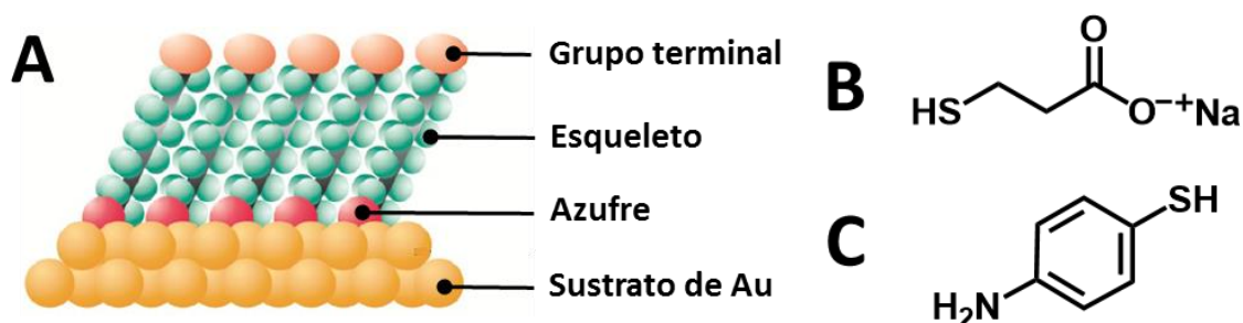
Figura 2.20. A Esquema de una SAM de tioles sobre un sustrato de Au. B Estructura del tior 3-mercaptopropan sulfonato de sodio (MPS). C Estructura del tior 4-aminotiofenol (4ATP).
