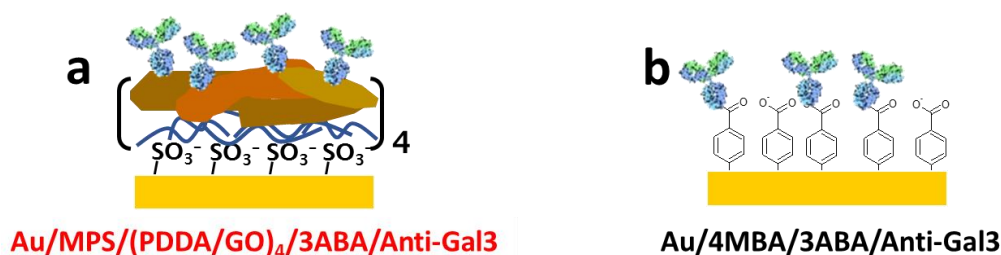
Figura 7.12. Esquema del biosensor construido sobre la plataforma optimizada de Au/MPS/(PDDA/GO) 4 /3ABA ( a ) y sobre la superficie de Au derivatizada con un tiol con grupos carboxilato ( b ).
