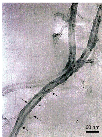
Figura 3.14. Imagen TEM de una dispersión de BCNT-dsDNA donde se puede apreciar una molécula de dsDNA dispersando un BCNT individual. Las flechas indican el enrollamiento del dsDNA alrededor del nanotubo.
