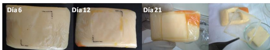
Figura 3.3.10. Inhibición de mohos en la superficie de queso fresco en contacto con película ACTIVA (BOPP- g- AA + NAT).
