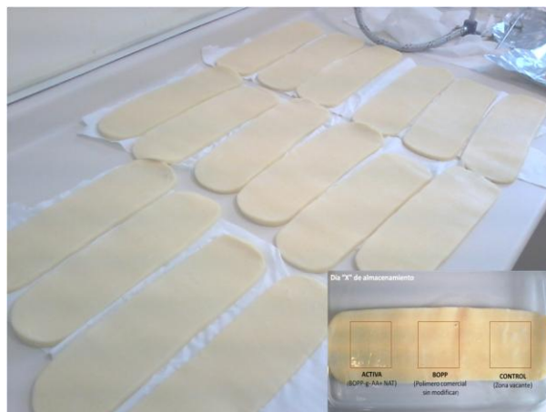
Figura 2.3.7. Porciones de queso para ensayo de efectividad antifúngica en queso y disposición de las películas a testear en contacto con la superficie del alimento.
