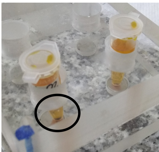
Figura 3.7. Proceso de remoción de la membrana de alúmina. La elipse negra resalta los nanohilos que están aglomerados al fondo del eppendorf, bajo el efecto de un imán.
