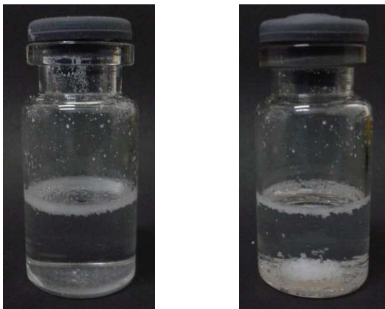
Figura 3.5.1.1. Imagen del licor extracto obtenido de la síntesis de [CTA^+ \cdots BH_4^-] para diferentes estadios: (izq.) inicio de la reacción (der.) final de la reacción.
