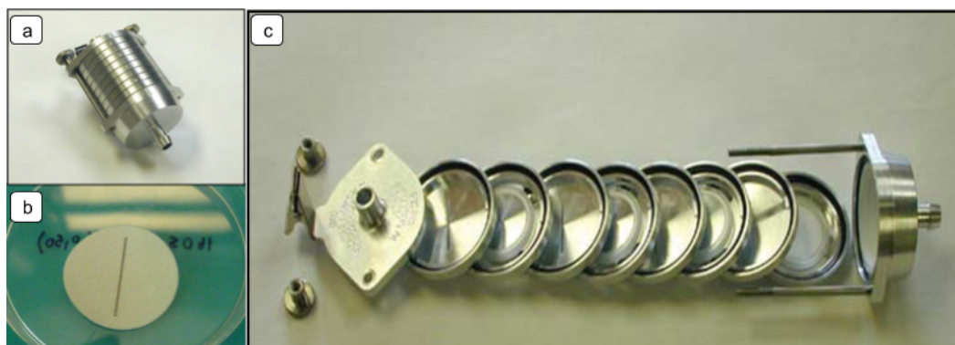
Figura 7.1: Impactador en cascada Sioutas a) cerrado y c) abierto. b) Filtro con material particulado depositado en forma de línea.
