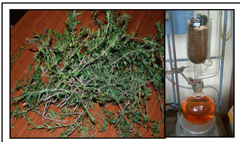
Figura 11. 1. (I) Material vegetal recolectado. (II) Extracción del material vegetal en aparato soxhlet.
