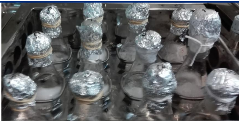
Figura 8.12. Tratamientos estudiados con sus respectivos controles en el caldo H 1 . Baño termostatzado con agitación.
