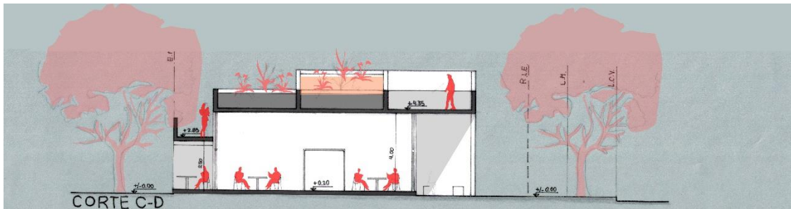
Fig. 20. La inversión de los pórticos con losas colgadas, permite cubrir libremente espacios de distinto calibre y diversa modulación sin la interferencia de vigas en el cielorraso de planta baja. En el plano de cubierta, estos elementos constructivos se transforman en canchales y barandas, posibilitando su apropiación.
