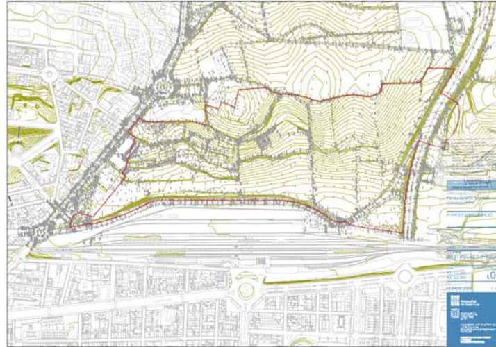
Plano de ESTADO ACTUAL Y TOPOGRAFIA en el que se representa el ámbito delimitado con línea de trazo discontinua roja, las curvas de nivel (cada 1,00 m) dibujadas con líneas de color verde, y construcciones (edificios, puentes, calles, ff-cc, muros, etc.) representadas con líneas grises.
