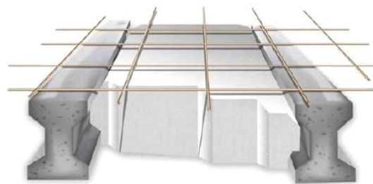
Bloque de poliestireno sostenido por dos vigüetas pretensadas
