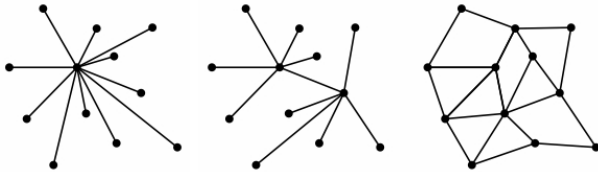
Estructuras de red de Baran: centralizada, descentralizada, distribuida.
