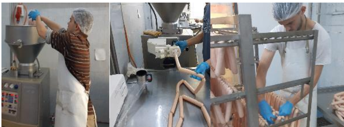
Figura 12: Proceso de embutido e hilerado de las salchichas
