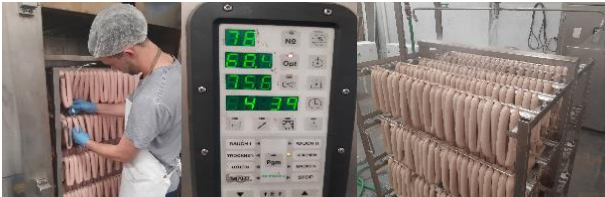
Figura 13: Proceso de cocción/ahumado de las salchichas
