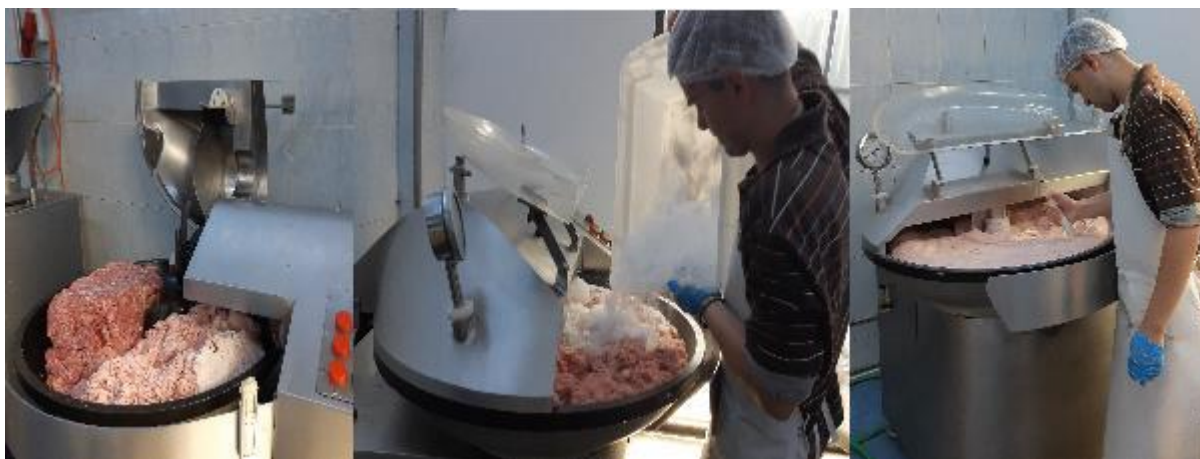
Figura 11: Proceso de triturado, sazonado de la masa cárnica para lograr una emulsión
