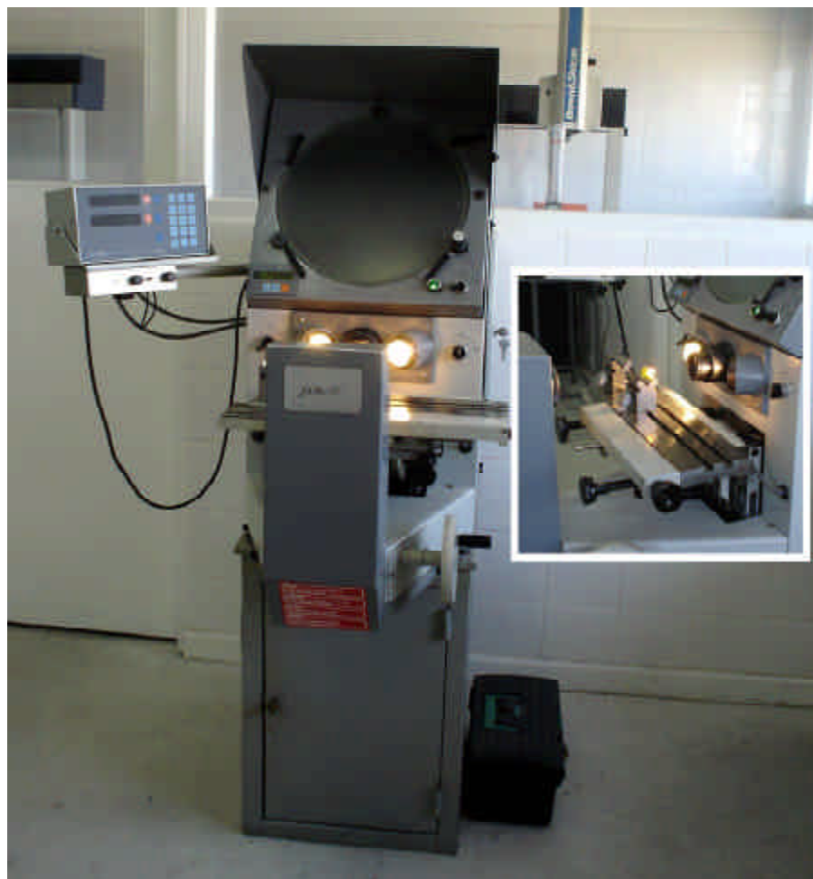
Figura 3: proyector digital de perfiles marca PRAZIS®, inset: detalle de la fijación de la muestra para ser medida.
