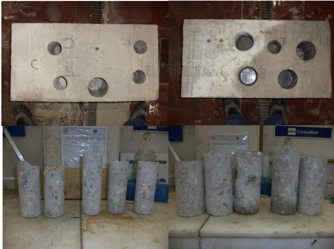
*Figura 5.3 Lugares donde se realizaron las extracciones en los bloques y testigos extraídos.*
