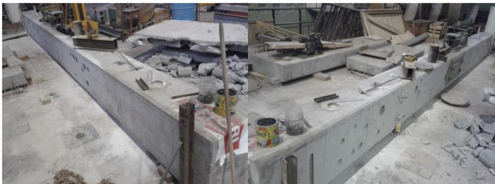
*Figura 6.5 Columna donde se realizaron las extracciones.*
