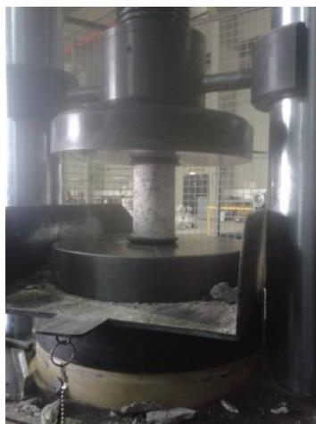
*Figura 4.6 Testigo siendo ensayado.*
