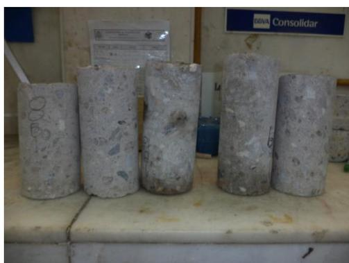
Figura 5.2 Testigos extraídos en donde se puede ver que la granulometría del árido es de 6- 19mm.
