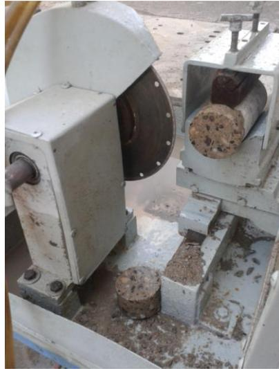
*Figura 4.3 Testigo siendo aserrado.*
