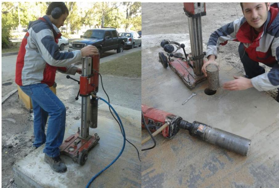
*Figura 7.9 Extracción de testigos.*
