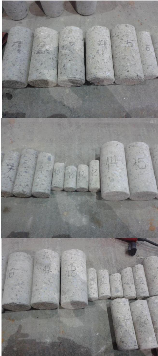
*Figura 7.12 Testigos extraídos de la losa.*
