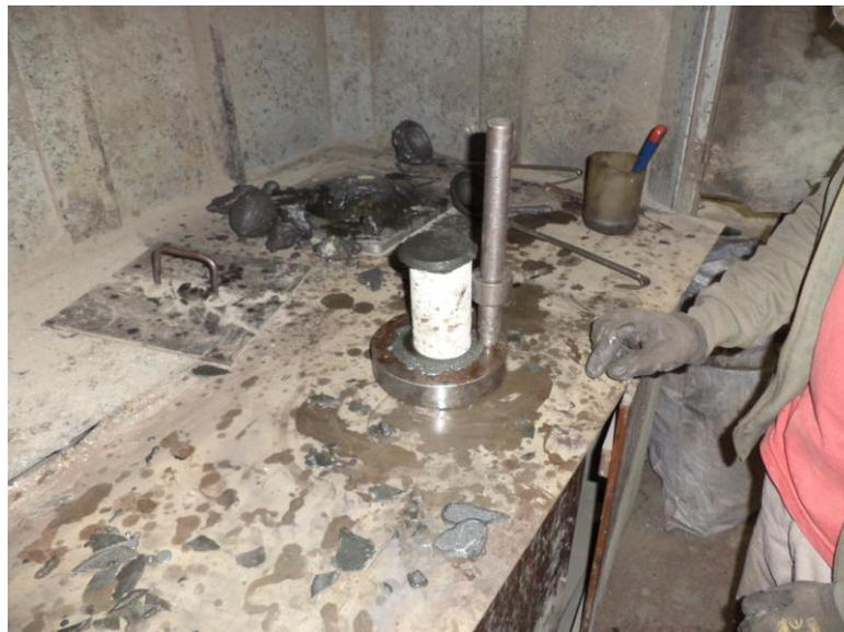
*Figura 4.4 Testigo siendo encabezado.*
