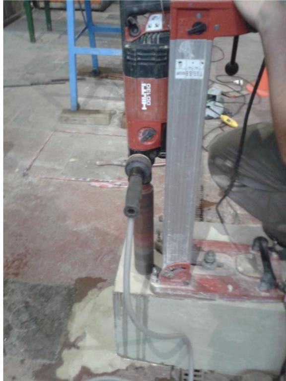
Figura 5.5 Equipo extractor en funcionamiento sobre el bloque.
