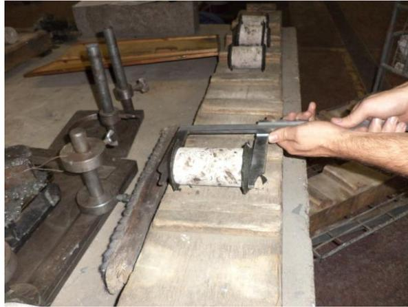
*Figura 4.5 Testigo siendo medido.*
