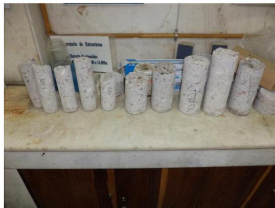
*Figura 5.4 Testigos extraídos de los bloques*
