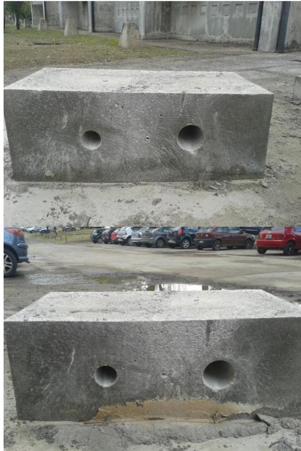
*Figura 7.11 Bloque con testigos extraídos en dirección perpendicular a la de hormigonado.*
