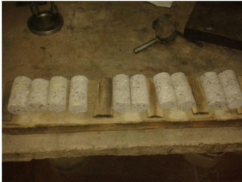
*Figura 6.4 Testigos de 63mm de diámetro extraídos.*
