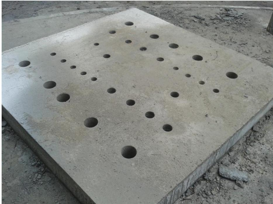
*Figura 7.10 Losa con testigos extraídos.*
