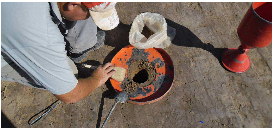
Fig.4.173: Los restos de suelo sobre el plato son retirados con una pinceleta de mano N° 20. Sección II.
