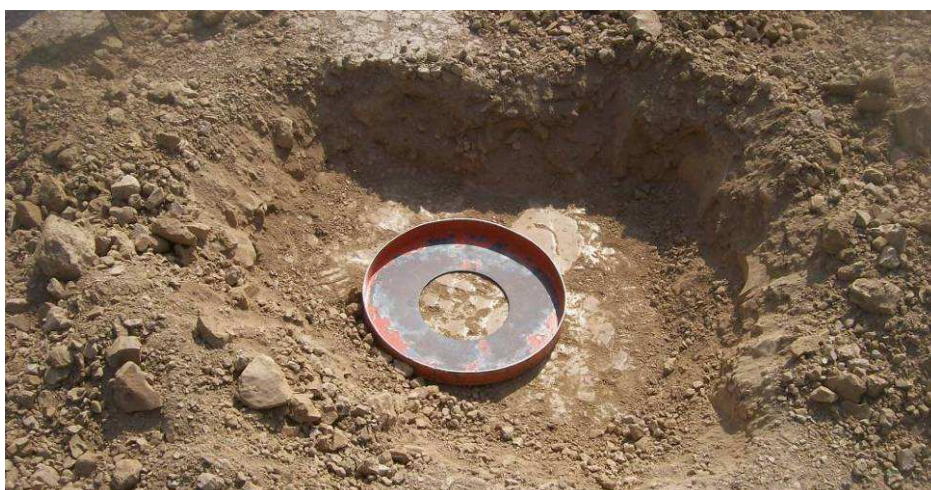
Fig.4.181: Ensayo de densidad de capa inferior sin analizar. Progresiva 17+850 Sección II.
