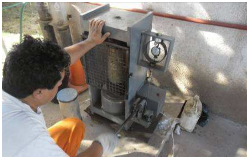
Fig. 4.112: Ensayo de resistencia a compresión, sobre probetas de hormigón. Sec. II.
