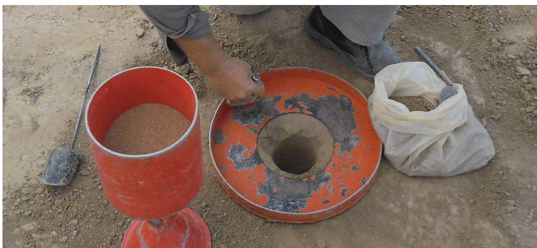
Fig.4.174: Los restos de suelo sobre el plato son retirados con una pinceleta de mano N° 20 y colocados en la bolsa junto al suelo extraído del pozo. El plato debe quedar perfectamente limpio. Sección II.
