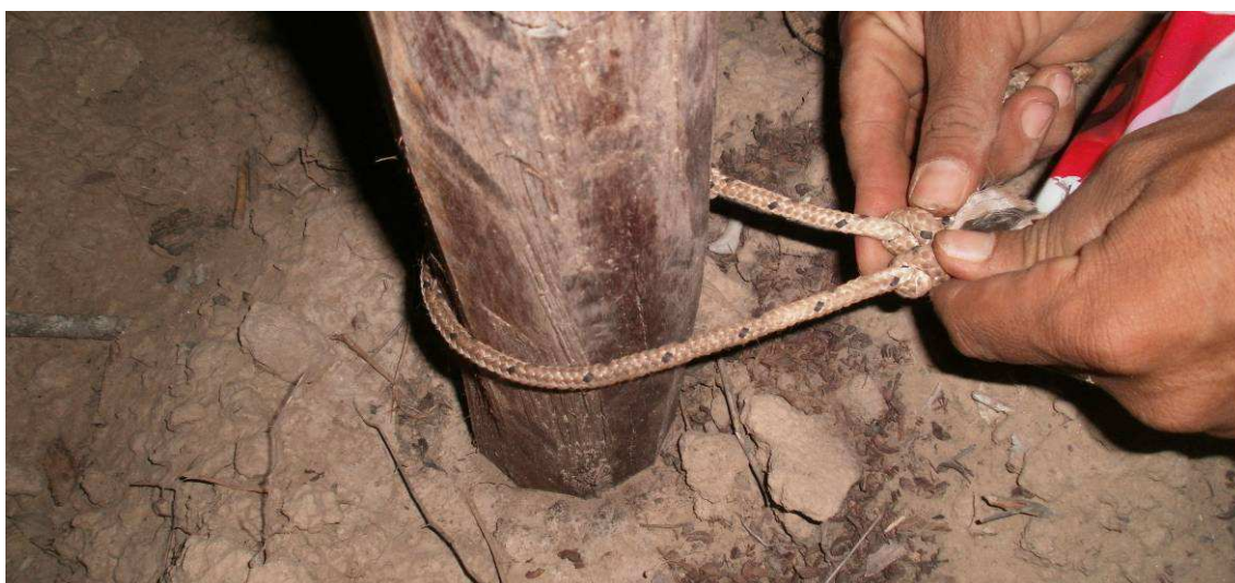
Fig.4.70: Poste rechazado por no cumplir con el diámetro mínimo en la base y en la punta. Prog. 0+000 y 1+500 lado derecho, Sec III.
