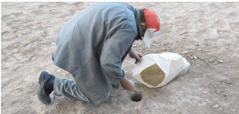
Fig.4.179: Recolectado del arena del cono inferior que había quedado dentro del pozo. Sección II.
