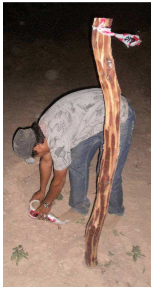
Fig.4.71: (Izq.): Poste rechazado por no cumplir con el diámetro mínimo en la base y en la punta y por tener doble curvatura. Descartado Prev. por inspección en obrador. Fig.4.72 (Der.): Poste rechazado por no cumplir con el diámetro mínimo en la base y en la punta. Descartado Previamente por inspección en obrador. Fotos pertenecientes a Prog. 0+000 y 1+500 lado derecho, Sec III.
