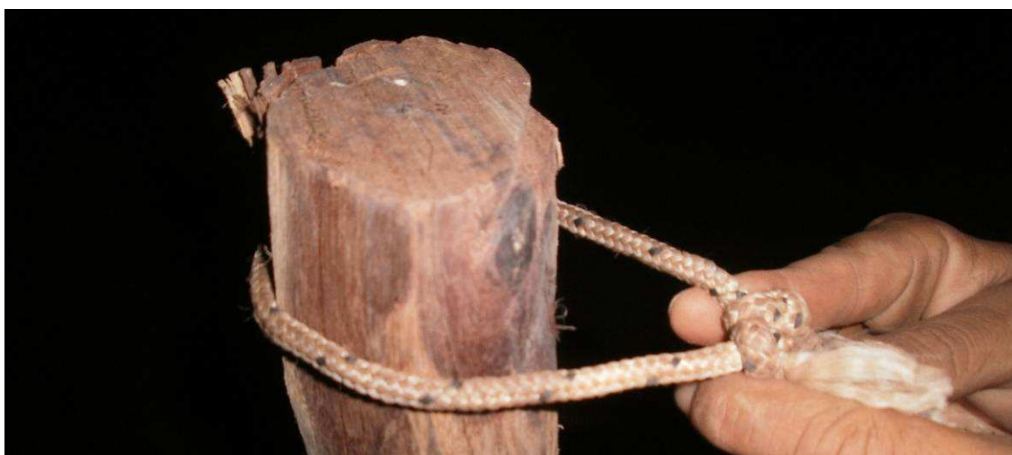
Fig.4.69: Poste rechazado por no cumplir con el diámetro mínimo en la base y en la punta. Prog. 0+000 y 1+500 lado derecho, Sec III.
