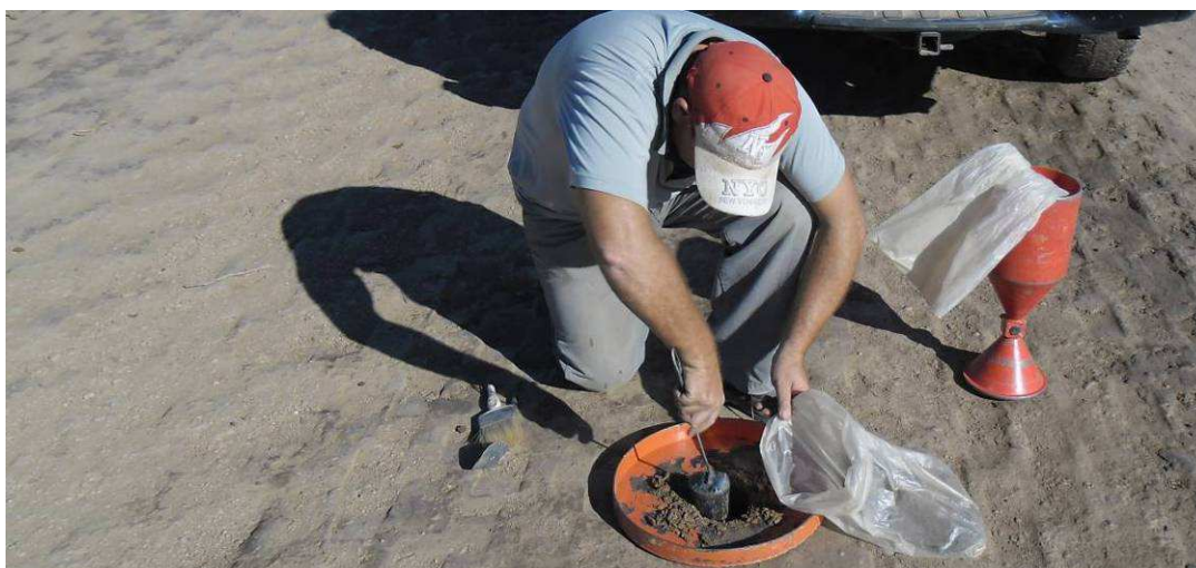
Fig.4.171: A los 20cm de prof. se finaliza con la perforación y se retira el suelo con otra herramienta, un cucharín de mano. Sección II.
