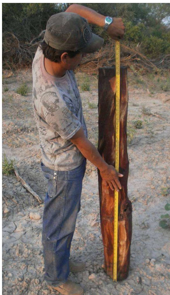
Fig.4.62 (Izq.): Poste rechazado por flecha mayor a la admisible (10cm). Descartado Prev. Por inspección en obrador. Prog. 0+000 y 1+500 lado derecho, Sec III.
