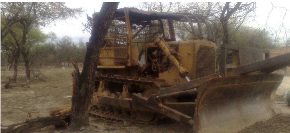
Fig.4.45: Topadora utilizada para el desbosque en Sección II.
