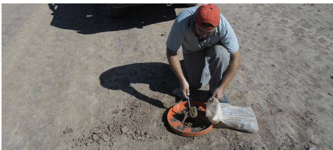
Fig.4.172: A los 20cm de profundidad se finaliza con la perforación y se retira el suelo con otra herramienta, un cucharín de mano. Sección II.
