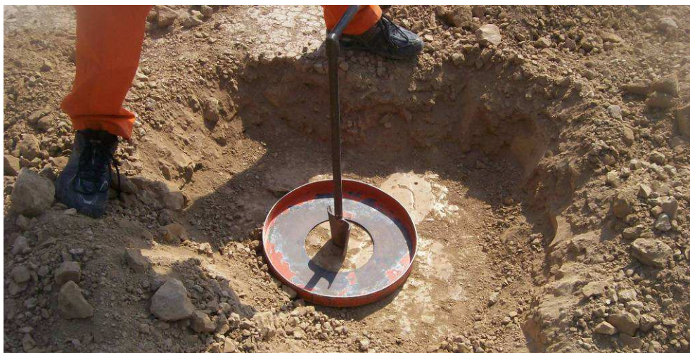
Fig.4.182: Ensayo de densidad de capa inferior sin analizar. Progresiva 17+850 Sección II.
