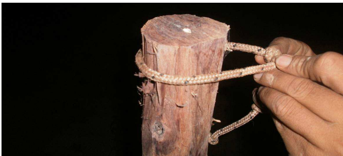
Fig.4.74: Poste rechazado por no cumplir con el diámetro mínimo en la base y en la punta. Prog. 0+000 y 1+500 lado derecho, Sec III.
