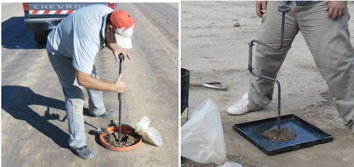
Fig.4.169: Excavando el pozo para realizar el ensayo del cono de arena. Sección II. La herramienta para el excavado fue una pala perforadora con manivela metálica.
