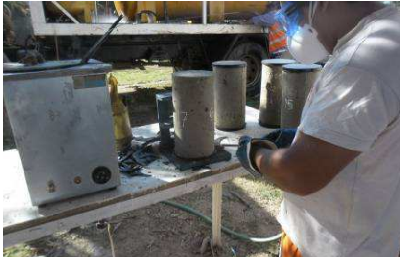
Fig.4.111: Encabezado de probetas de hormigón. Sec. II.
