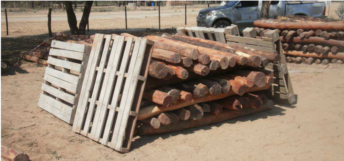
Fig.4.46: Postes aprobados por la Inspección en obrador de JCR de Lamadrid.
