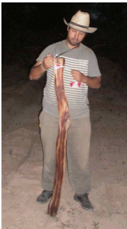
Fig.4.71: (Izq.): Poste rechazado por no cumplir con el diámetro mínimo en la base y en la punta y por tener doble curvatura. Descartado Prev. por inspección en obrador. Fig.4.72 (Der.): Poste rechazado por no cumplir con el diámetro mínimo en la base y en la punta. Descartado Previamente por inspección en obrador. Fotos pertenecientes a Prog. 0+000 y 1+500 lado derecho, Sec III.
