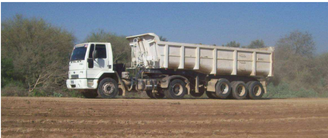
Fig. 8.34: Camión transportando suelo del préstamo a la zona de trabajo.
