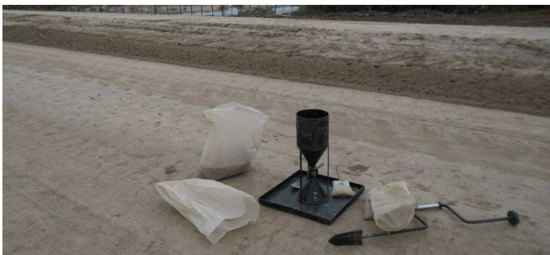
Fig.4.183: Herramientas necesarias para realizar el ensayo de densidad mediante el Cono de Arena.
