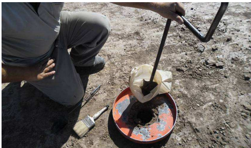
Fig.4.170: Recolectando el suelo del pozo para posterior análisis en laboratorio. Sección II.
