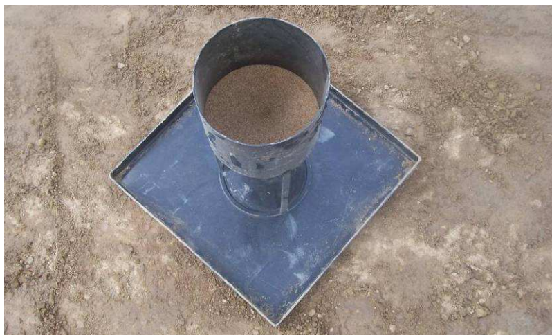
Fig.4.177: Se coloca el cono con arena normalizada sobre el pozo, se abre la llave intermedia para que se llene el pozo y el cono inferior con dicha arena. Sección II.
