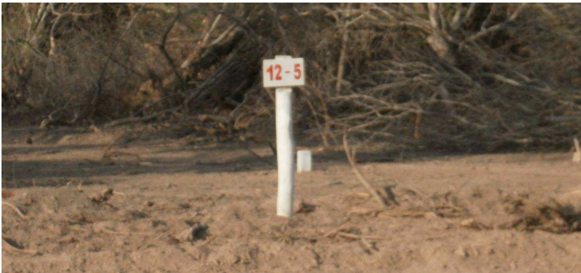
Fig.4.36: Punto Fijo en progresiva 12+500 de Sección II.
