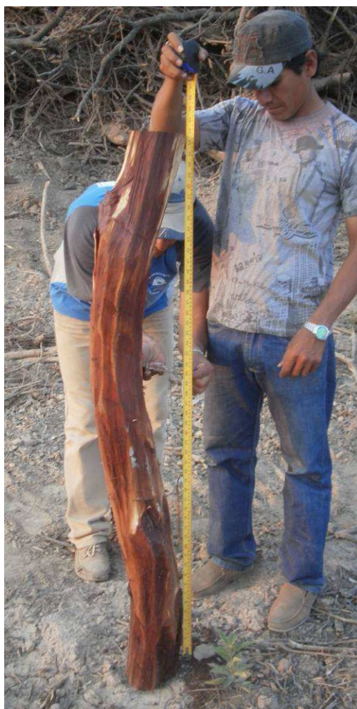
Fig.4.62 (Izq.): Poste rechazado por flecha mayor a la admisible (10cm). Descartado Prev. Por inspección en obrador. Prog. 0+000 y 1+500 lado derecho, Sec III.
