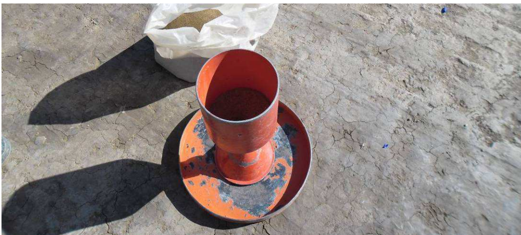
Fig.4.176: Se coloca el cono con arena normalizada sobre el pozo, se abre la llave intermedia para que se llene el pozo y el cono inferior con dicha arena. Sección II.
