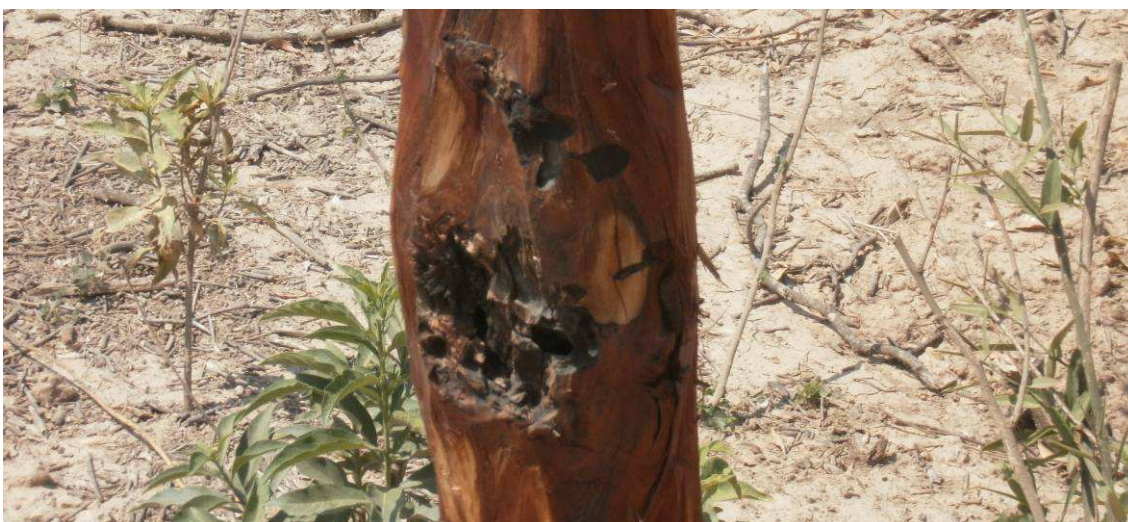
Fig.4.57: Poste en mal estado rechazado por inspección previamente en obrador. Posteo entre Prog. 0+000 y 1+500 lado derecho, Sección III.
