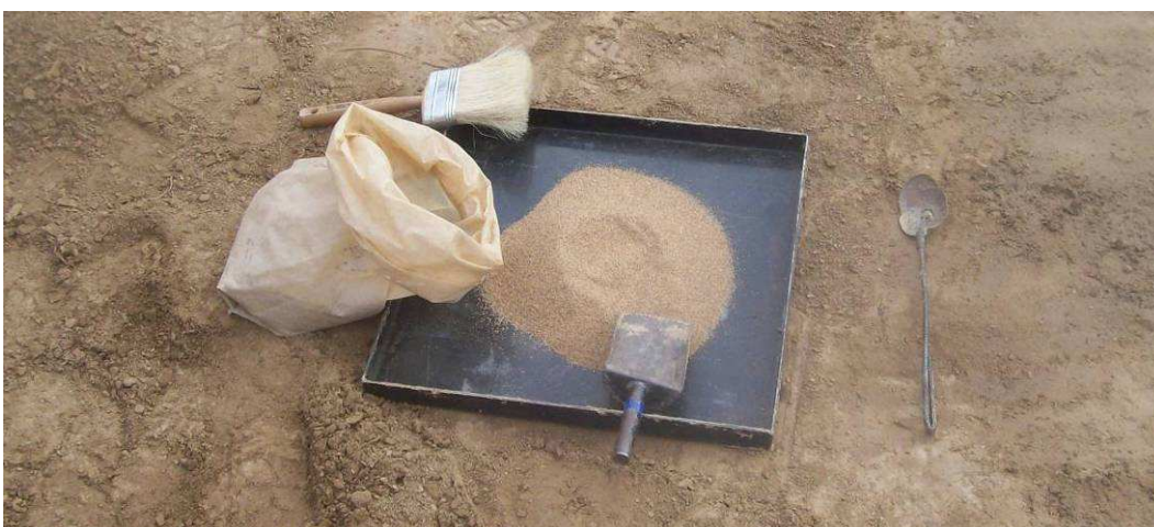
Fig.4.178: Se retira el cono guardando en una bolsa el arena del cono superior para Posterior análisis en laboratorio. El arena del cono inferior se la recolecta en otra bolsa. Sección II.
