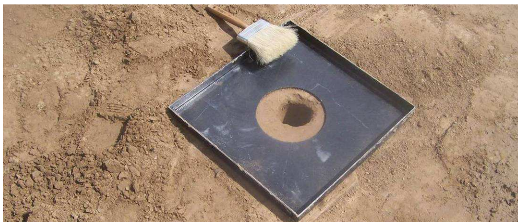
Fig.4.175: Los restos de suelo sobre el plato son retirados con una pinceleta de mano N° 20 y colocados en la bolsa junto al suelo extraído del pozo. El plato debe quedar perfectamente limpio. Sección II.
