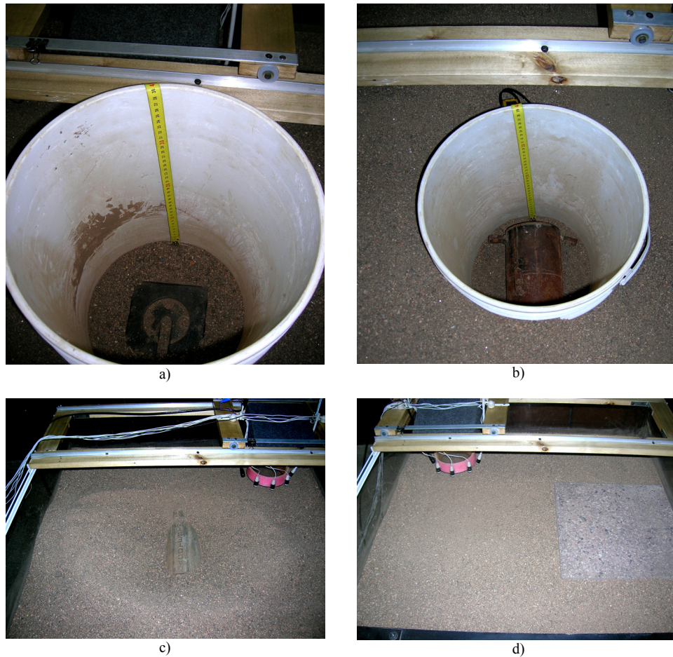
Figura VI.6: Imágenes fotográficas en donde se muestran la manera en como se ubicaron aquellos objetos de menor tamaño a diferentes profundidades y de aquellos objetos dispuestos a nivel superficial, en la celda con arena.
