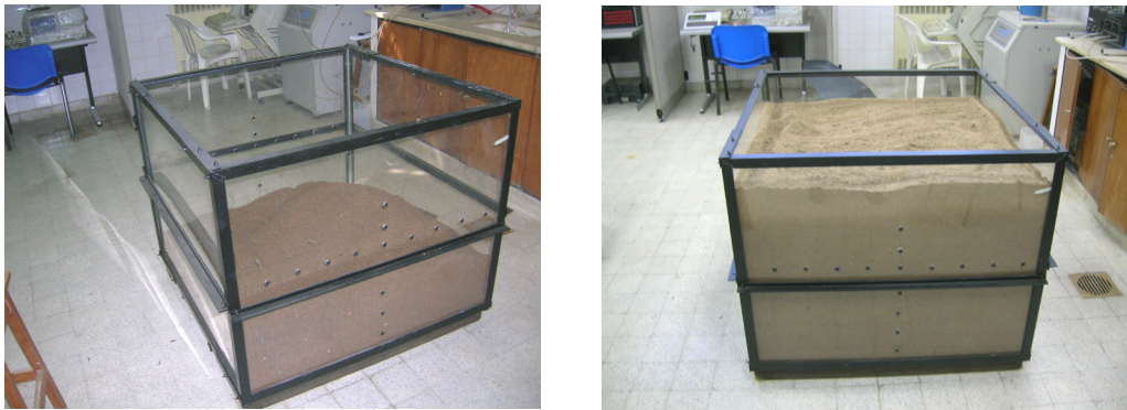
Figura IV.1: Imágenes correspondientes a la celda con arena utilizada en los experimentos como medio propagante, denominada de aquí en más como “el medio arena”.
