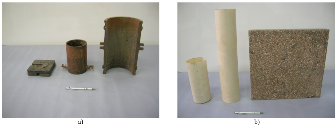
Figura VI.4: Imágenes fotográficas de los diferentes objetos utilizados para realizar las prospecciones en el medio arena a través del sistema prototipo de ecografía acústica.
