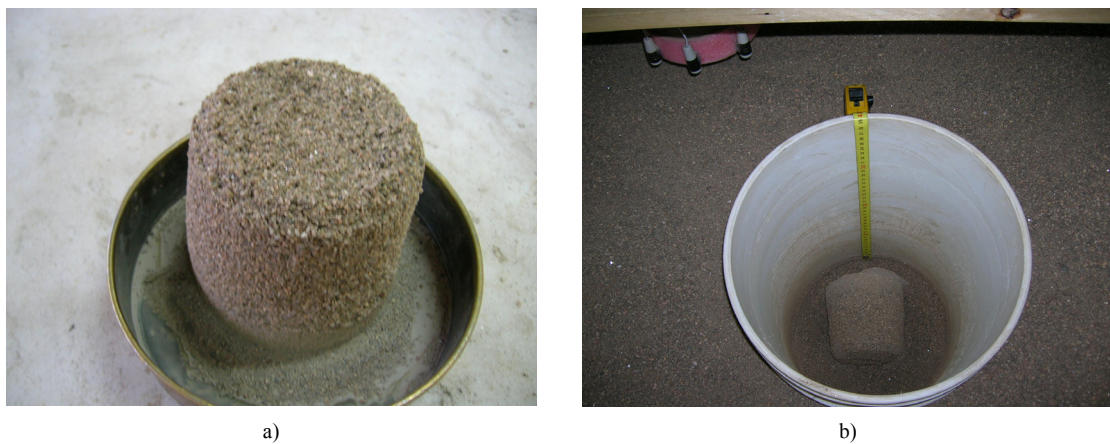
Figura VI.15: a) Imagen fotográfica de la probeta de arena densificada de 13 cm de diámetro por 15 cm de largo y de una densidad seca de 1.61 gr / cm 3 . b) Imagen fotográfica en donde se muestra la manera en como se ubicó la probeta de arena, a la profundidad de 20 cm en la celda con arena.
