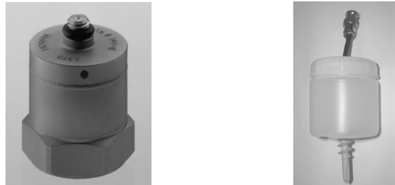
Figura IV.8: Imagen del acelerómetro Brüel & Kjær modelo 4378 y recipiente de resguardo, utilizados en los experimentos.
