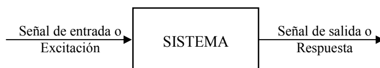
Figura III.3: Esquema de sistema, señal de entrada y respuesta o salida del sistema.
