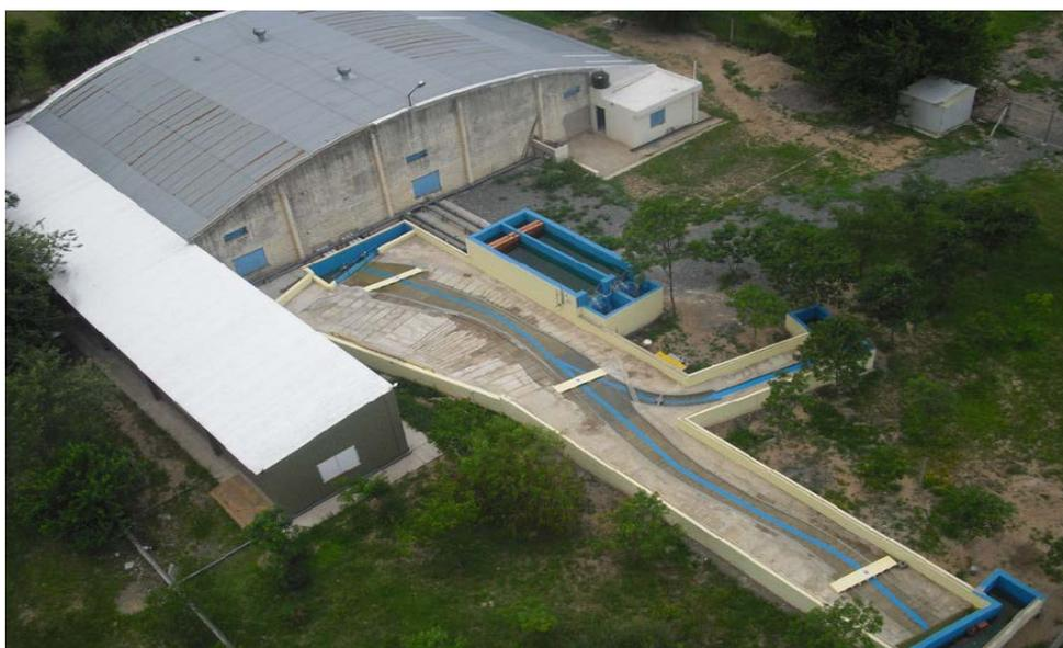
**Figura 3.1 Modelo físico de la confluencia del arroyo La Cañada y el río Suquía (Laboratorio de Hidráulica de la Universidad Nacional de Córdoba).**
