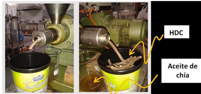
Figura 8. Proceso de extracción de aceite de la semilla de chía a escala piloto y obtención de la HDC
