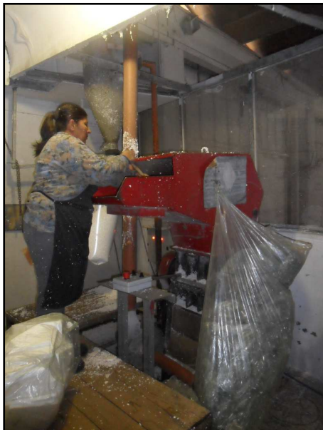
Ilustración 7.27 Trituradora de “Telgopor”.
