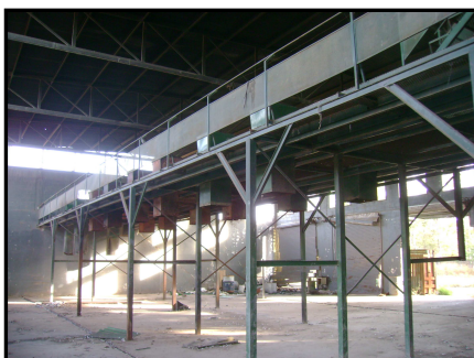
Ilustración 4.2- Cinta de selección de Planta de Selección de Residuos Inorgánicos Reciclables.
