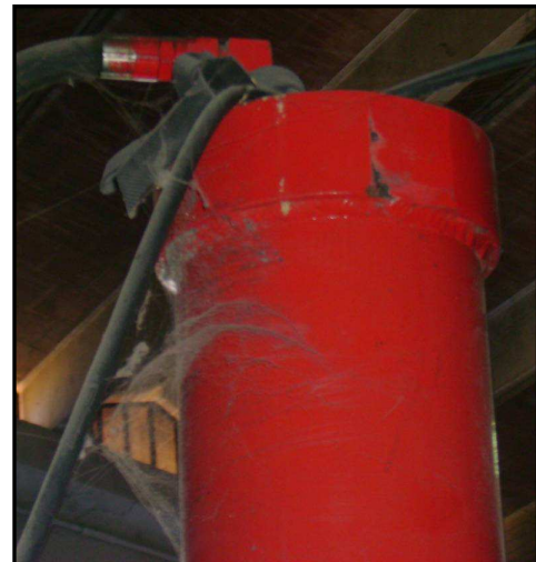
Ilustración 9.6- Polvillo y telarañas en prensa hidráulica para cartón B.
