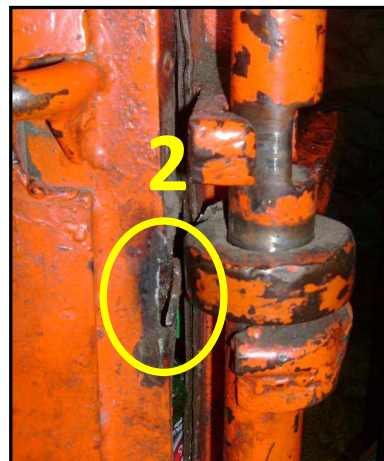
Ilustración 9.11- Agarre de la puerta desoldado, de prensa hidráulica doble canasto.
