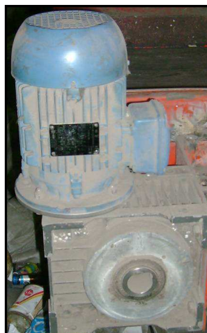
Ilustración 9.18- Motor y caja de transmisión de cinta transportadora de selección.
