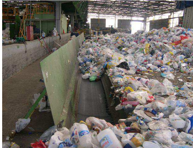
Ilustración 8.22- Cinta de carga de residuos ingresados.
