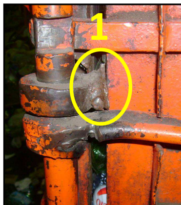
Ilustración 9.11- Agarre de la puerta desoldado, de prensa hidráulica doble canasto.
