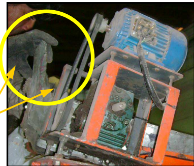
Ilustración 9.20- Correas y poleas de transmisión de cinta transportadora de Scrap.
