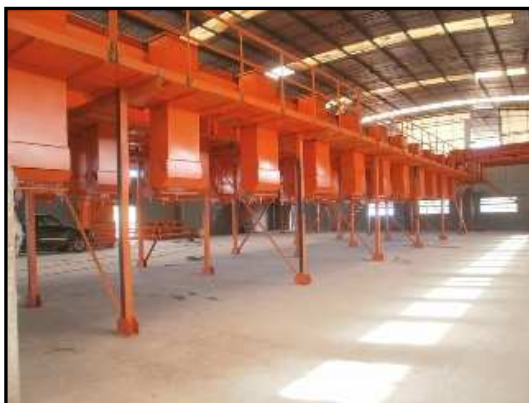
Ilustración 8.27- Tipos de cintas de selección elevadas, extraída de plantas y equipos para el tratamiento de residuos sólidos (s.f).
