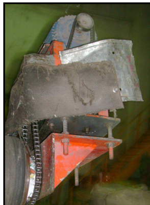
Ilustración 9.20- Correas y poleas de transmisión de cinta transportadora de Scrap.
