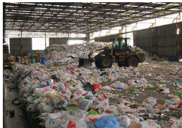
Ilustración 8.21- Pala mecánica acercando los residuos a la cinta de carga.
