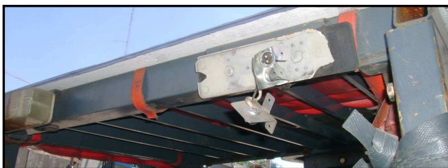
Ilustración 9.23- Luces rotas del autoelevador.
