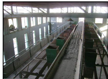
Ilustración 4.2- Cinta de selección de Planta de Selección de Residuos Inorgánicos Reciclables.
