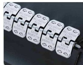
Ilustración 9.15- Cierres metálicos para unir bandas transportadoras.
