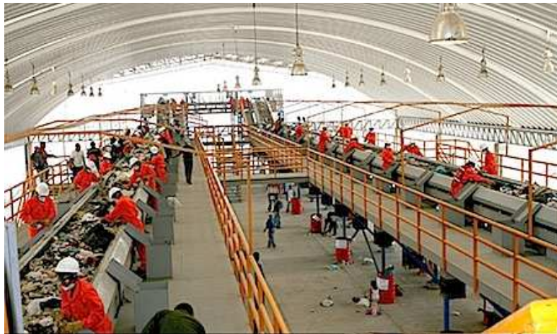
Ilustración 8.31- Cintas de selección paralelas.
