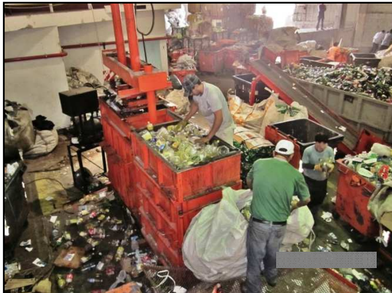
Ilustración 7.23 Prensa hidráulica doble canasto.
