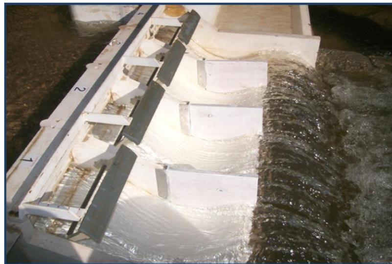
*Figura 22: Modelo en funcionamiento con separadores de flujo*
