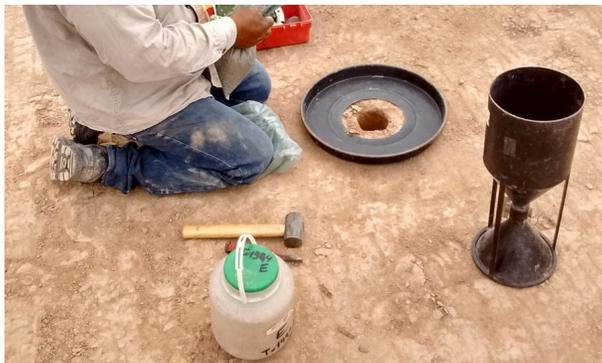
**Imagen 4.20 : Ensayo “cono de arena”.**
