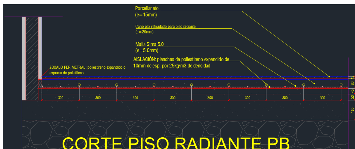
Figura 24 – Detalle losa radiante planta baja.
