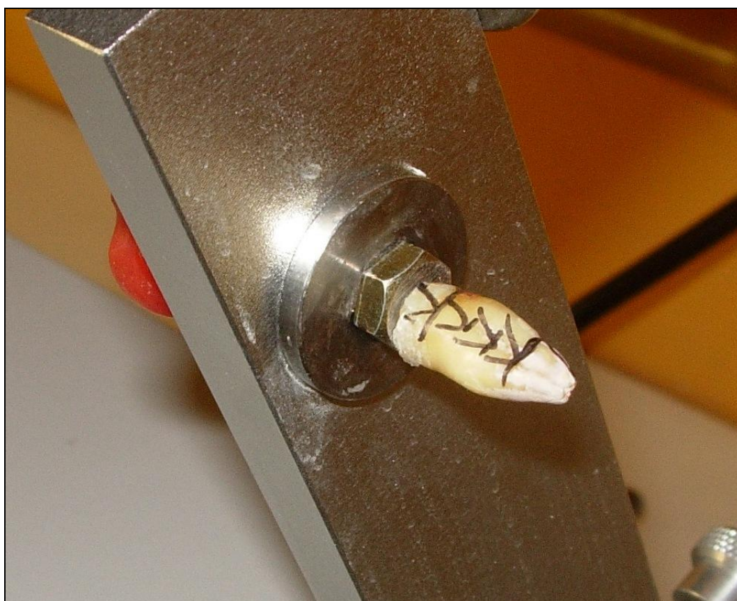
Imagen 6b: Muestra fijada en IsoMet Low Speed saw para ser cortada.
