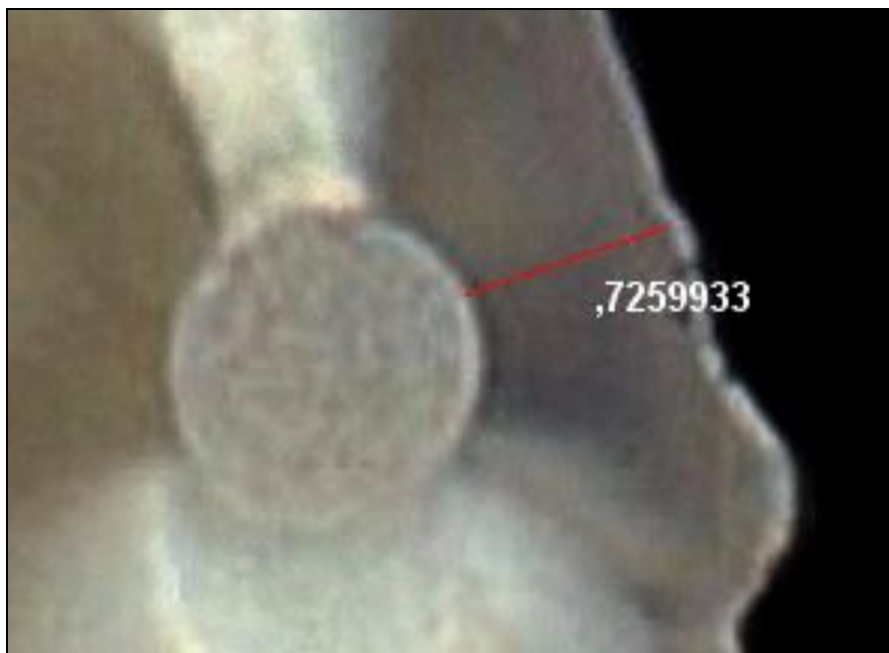
Imagen 22b: Medición en milímetros del mínimo espesor dentinario con el analizador de imágenes digitales (Image- Pro plus). Corte apical (sector 1).
