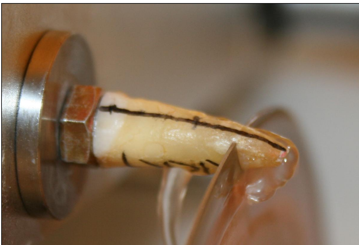
Imagen 6d: Corte de la muestra en la IsoMet Low Speed saw.
