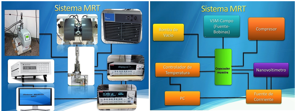
Figura 3.9: Sistema de medición de magnetorresistencia , equipo del grupo Ciencia de Materiales FAMAF-UNC
