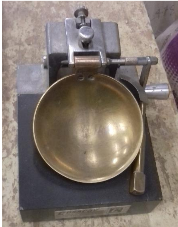
Imagen 7 - Aparato de Casagrande junto con su acanalador
