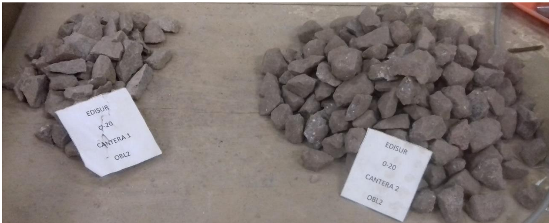
Imagen 26 - Retenidos por el tamiz de 19 mm de ambas canteras.
