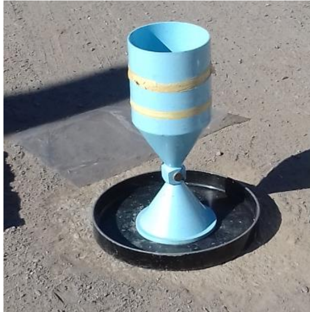
Imagen 42 - Ensayo de Cono de Arena en punto N°1
