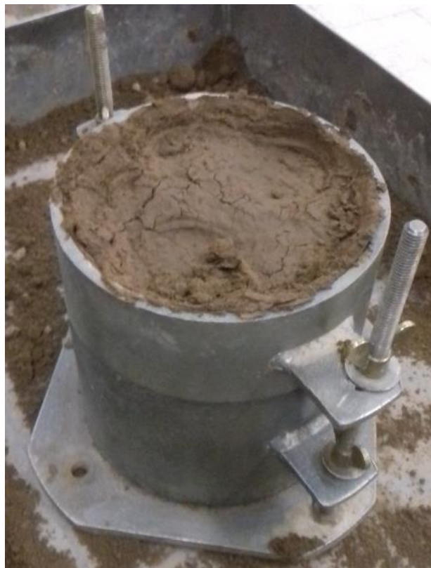
Imagen 61 - Compactación correspondiente al 4to punto del ensayo.
