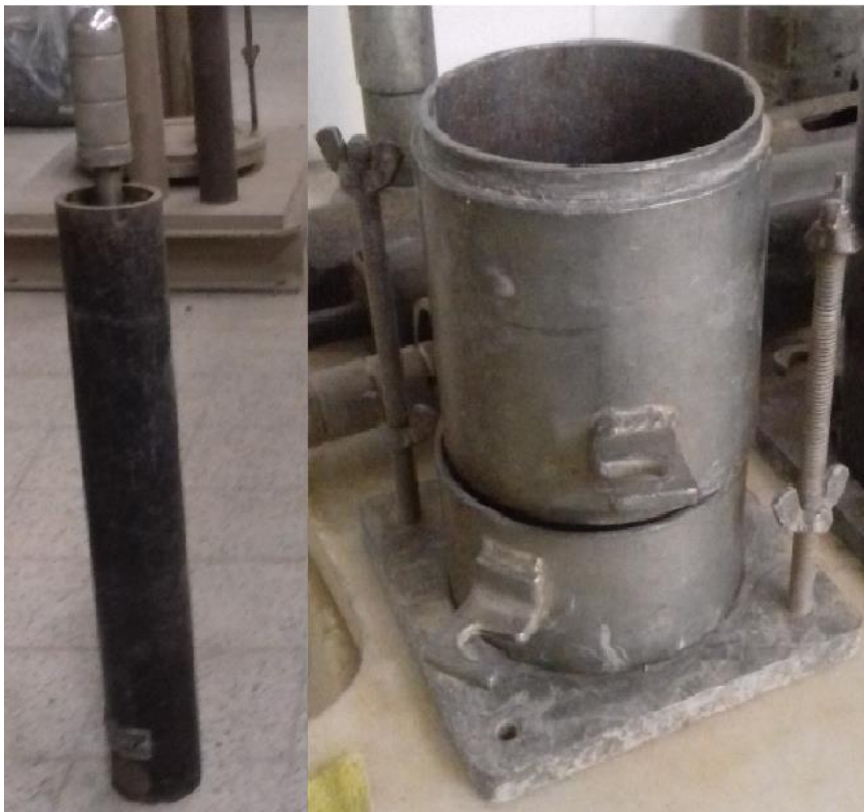
Imagen 50 - Pisón y molde de compactación utilizados.
