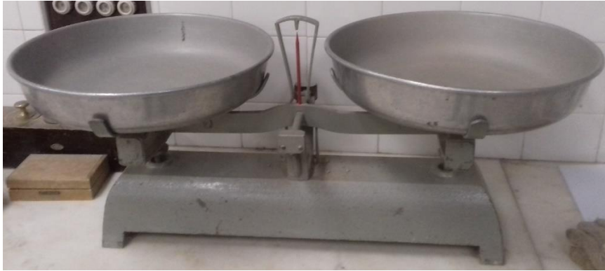
Imagen 51 - Balanza tipo "Roberval" de capacidad de 20 kg y precisión de 1 gr.
