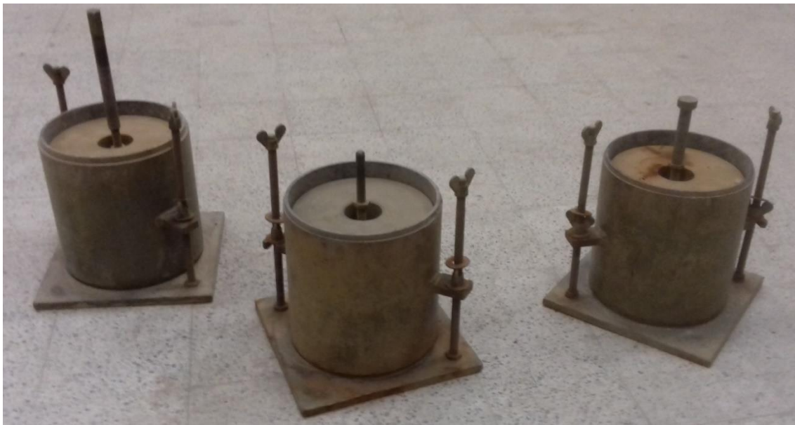
Imagen 15 – Primeras 3 probetas conformadas, momentos antes de la inmersión en agua.
