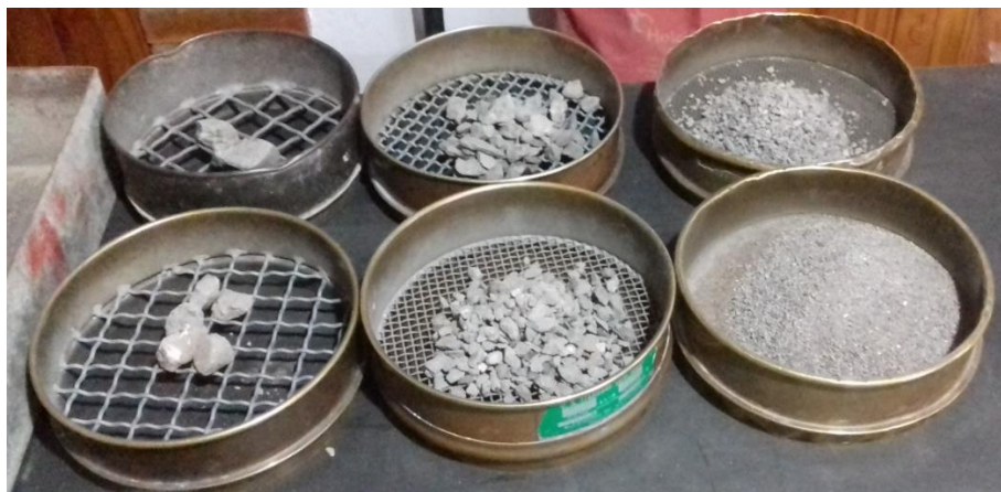
Imagen 5 - Tamices ordenados de arriba hacia abajo y de derecha a izquierda, desde el de mayor hacia el de menor abertura
