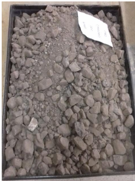
Imagen 24 - Material pasante del tamiz de 19 mm de la cantera N°2.
