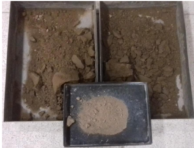
Imagen 62 - Diferencia de aspectos entre material seco (centro), con humedad de 14,5% (izq.) y con humedad de 17,6% (der.)
