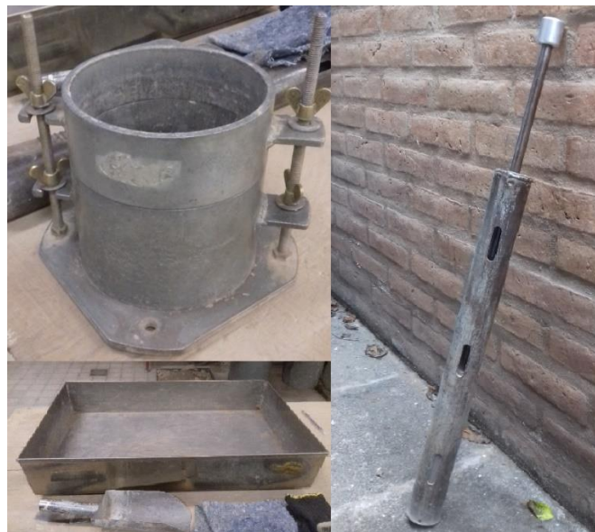
Imagen 13 - Molde, pisón, cuchara y bandeja utilizada durante el ensayo
