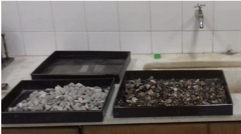
Imagen 53 - Proceso de saturación del retenido del tamiz N°4
