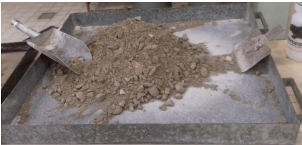
Imagen 56 - Mezclado y amasado del material granular, ligante y agua correspondiente al 2do punto del ensayo.
