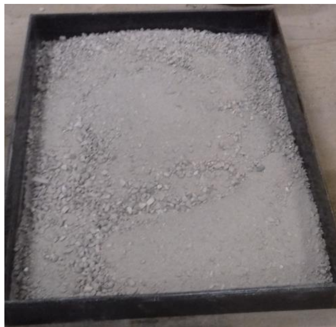
Imagen 54 - Mezcla de Ligante con el pasante del tamiz N°4.
