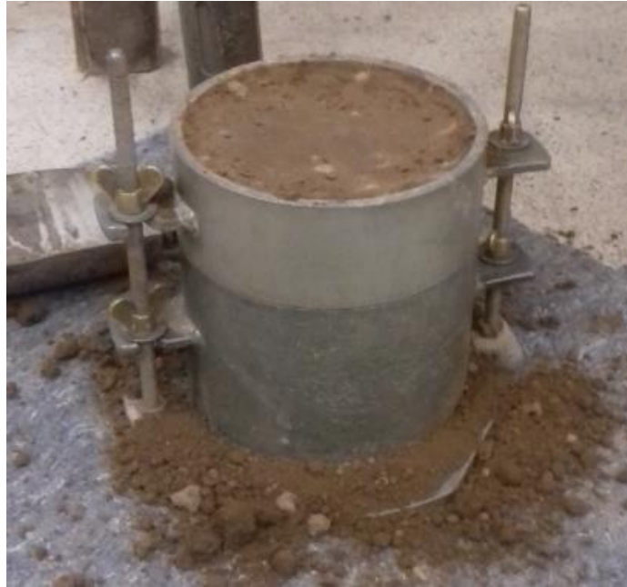
Imagen 60 - Compactación correspondiente al 2do punto del ensayo.
