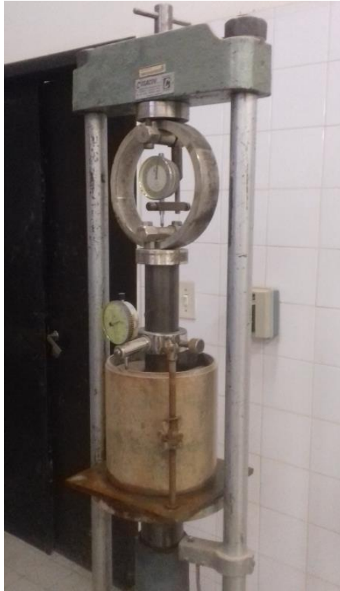
Imagen 17 - Prensa momentos antes de penetrar en la probeta N°2
