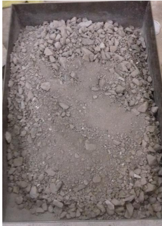
Imagen 22 - Material pasante del tamiz de 19 mm de la cantera N°1.
