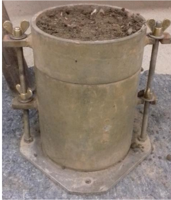
Imagen 14 - Probeta moldeada en 5 capas de 25 golpes por cada una.
