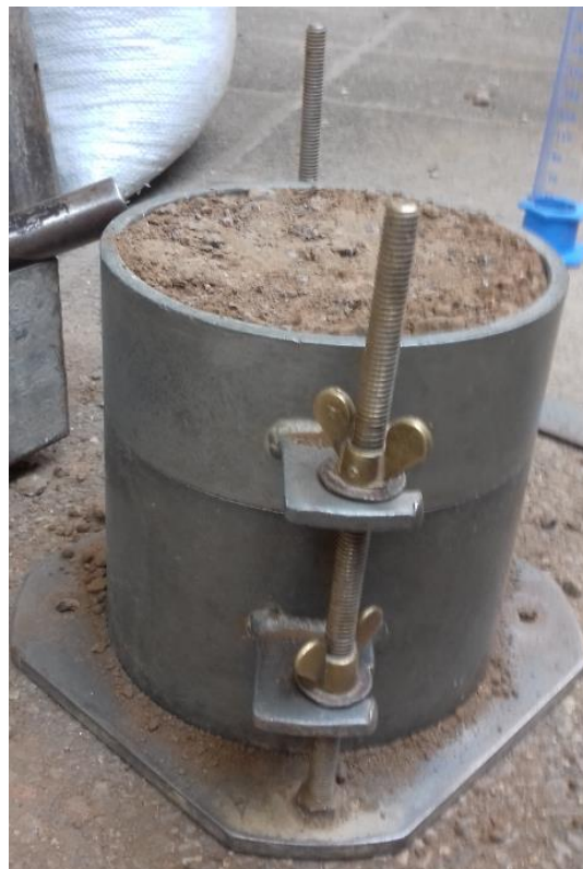
Imagen 11 - Proceso de compactación del punto N°2
