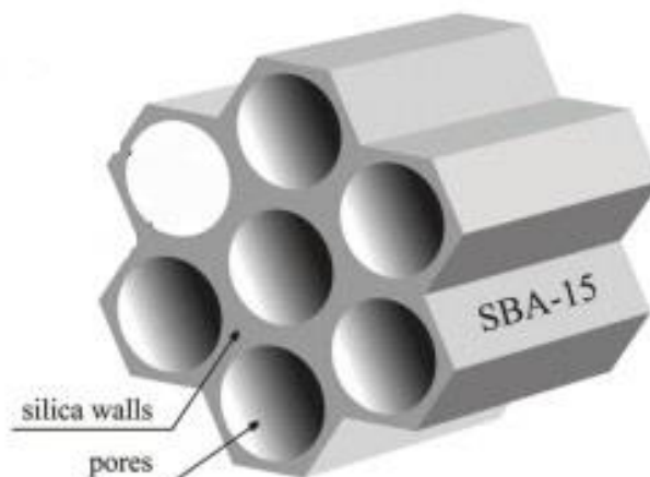
Figura 1.6 – Esquema del sistema poroso de SBA-15. Fuente: Laskowski et al., (2014).
