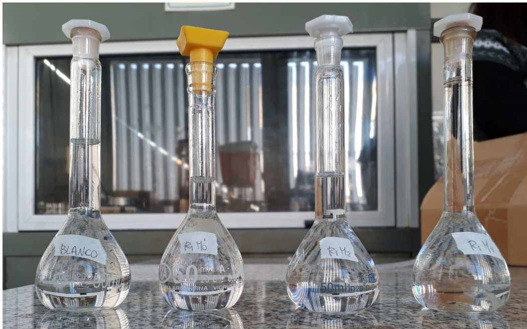
Matraces preparados para agregarles las muestras de reacción y llevarlas a determinación de peróxido de hidrógeno.
