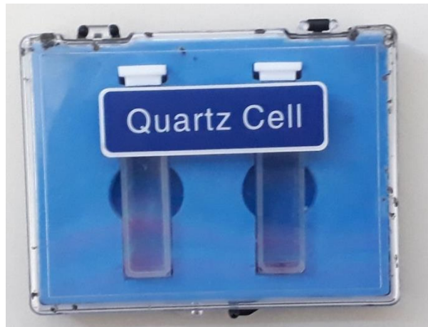
Celdas de cuarzo para ingresar la muestra al espectrofotómetro.
