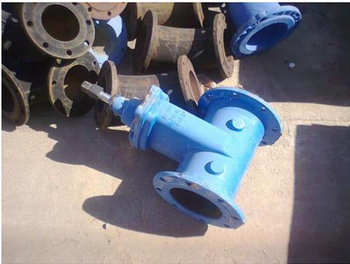
Válvula Esclusa Larga. Las hay de distintos diámetros, siempre metálicas. Tiene un vástago protegido por un capuchón recambiable y dos bridas. Al girar el vástago con una llave tipo "T" que debe ser robusta, asciende o desciende una compuerta interna que regula el paso del agua y resiste altas presiones.
