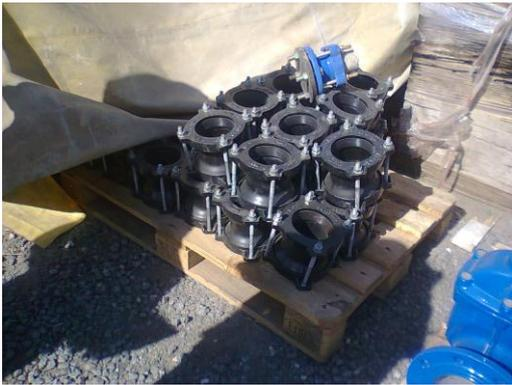
Otra forma de materializar una conexión es mediante cuplas. La cuplas son manguitos, como los vistos para cañerías de PRFV. También los hay de PVC y cuplas de electrofusión para PEAD.
