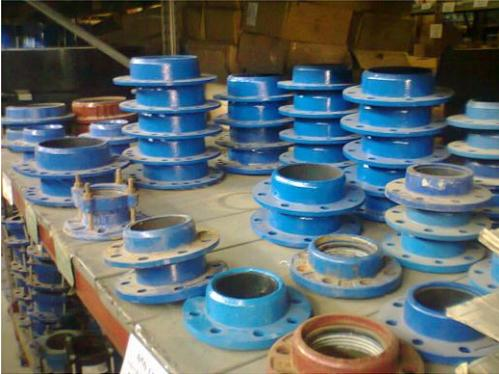
Una junta de goma cónica abraza y retiene al caño al ajustar la brida del adaptador con la brida de la válvula.
