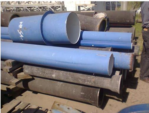
Caños de hierro fundido color negro de acero pintados con pinturas especiales, de distintos espesores de pared. Los caños azules de arriba requieren bridas, que van soldadas en los extremos de los caños y permiten, mediante una junta de goma, sellar la unión para resistir las presiones a las cuales se encuentra sometida la cañería en funcionamiento.
