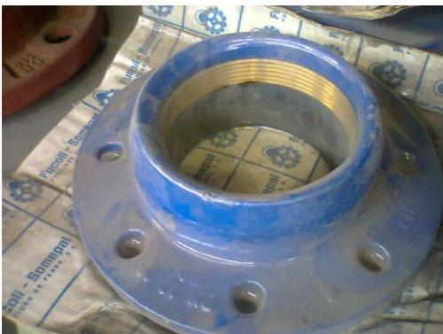
Adaptador de Brida Dentado. Utilizado para caños de PEAD. Debido a la ductilidad de dicho material, se hace necesaria amordazarlo de alguna manera. Los dientes de bronce, al ajustar la brida mediante bulones, penetran el material de manera que constituyen un buen anclaje para evitar el escape del caño.
