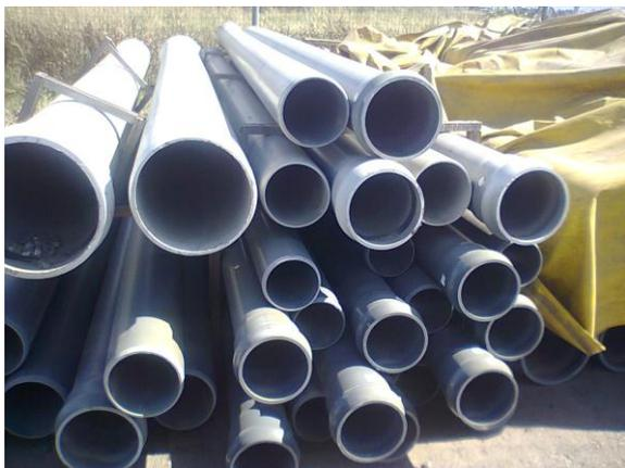
Caños de PVC, con una longitud de 6m, cuyo método de empalme se realiza por “espiga y enchufe”. Este diseño consta de un extremo macho y otro hembra el cual aloja un aro de goma que sirve de junta y propicia la hermeticidad de la cañería una vez colocada. Es importante para la colocación de los caños, tener en cuenta una correcta lubricación de dichas juntas por medio de un gel lubricante especial. El uso de grasa
