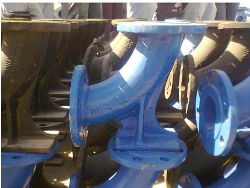
Las curvas, tanto por la fuerzas estáticas del agua como por las fuerzas dinámicas que produce el flujo, siempre deben anclarse. Las curvas con base permiten fijar una curva adecuadamente en un anclaje de hormigón. La curvas con base se utilizan para la colocación de hidrantes, ya que los cabezales se colocan a nivel de vereda en la parte superior de una columna cuya parte inferior es la curva.
