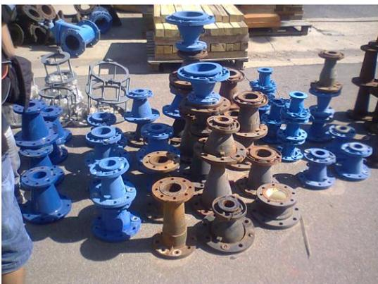
A la izquierda tenemos reducciones de hierro fundido con brida fija y adaptable.
