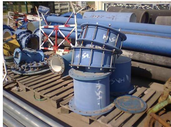
Las Conexiones de Amplia Tolerancia están diseñadas para materializar un empalme entre distintos diámetros y materiales de caño, lo cual conlleva un problema de deformaciones diferenciales entre ambos. Estas conexiones tienen un rango de diámetros admisible. El sellamiento se realiza mediante una junta en forma de aro de goma cónica que se cierra al ajustar los bulones. De esta manera la junta aprieta al caño siempre que este se encuentre dentro del rango establecido.
