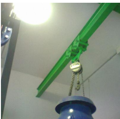
Figura 5.15 – Monorrailes con aparejo manual a cadena para los sistemas de baja presión (provisorio) y alta presión
