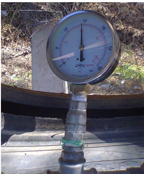
Figura 5.32 – Manómetro para pruebas hidráulicas
