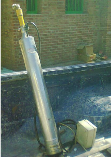
Figura 5.30 – Bomba sumergible trifásica de 3HP
