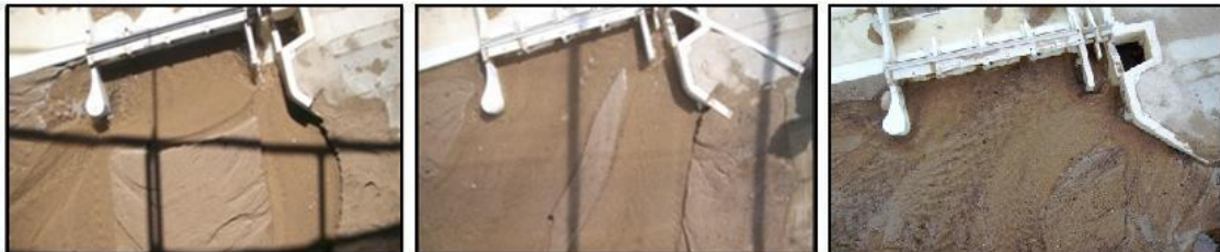
Figura 56: Ensayos: (a) sin aporte, (b) con aporte manual, (c) con aporte continuo. Escenario en que se espera la crecida con compuertas cerradas
