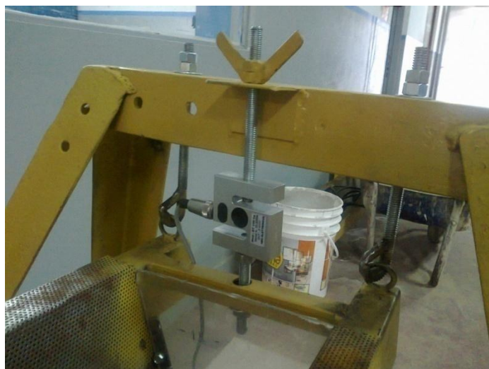
Figura 44: Celda de carga instalada en tolva
