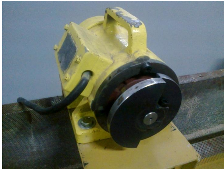
Figura 34: Motor vibratorio de excentricidad regulable
