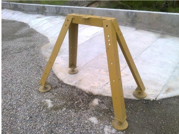
Figura 35: Soporte de las tolvas
