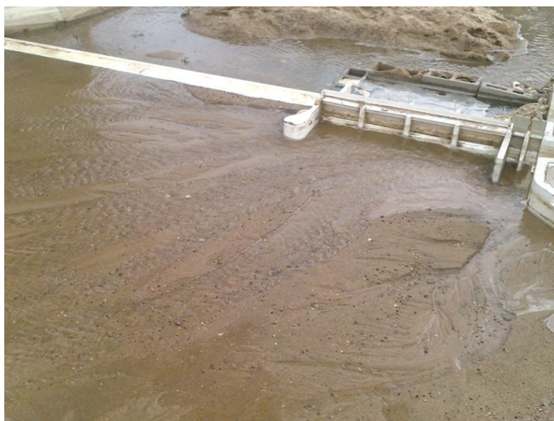
Figura 48: Ensayo en que se espera la crecida con compuertas cerradas con aporte de sedimentos continuo. 60 minutos
