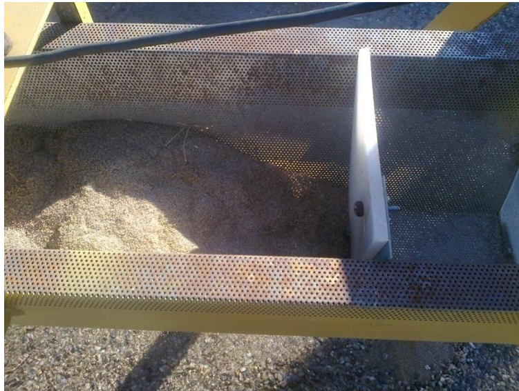
Figura 40: Vista lateral del limitador de aporte de sedimento
