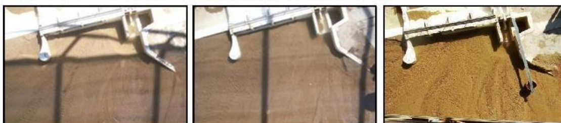
Figura 64: Ensayos: (a) sin aporte, (b) con aporte manual, (c) con aporte continuo. Escenario en que se espera la crecida con compuertas abiertas
