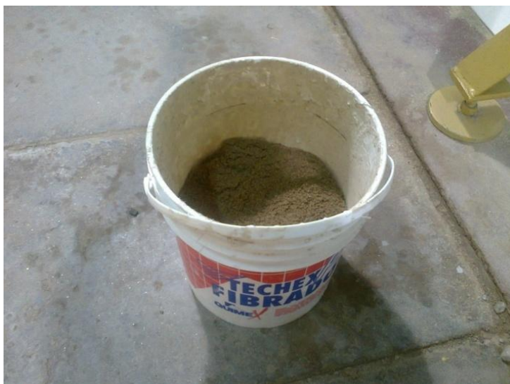
Figura 38: Medición de volumen de arena para calibración
