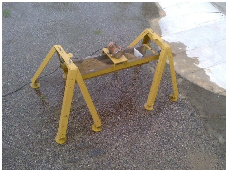
Figura 37: Tolva vibratoria armada sobre el cauce del río en el modelo físico
