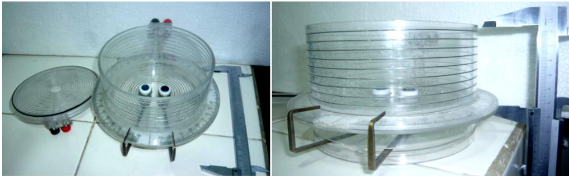
Figura 8: Celda para crecimiento de monocristales y bicristales, vistas superior y lateral.
