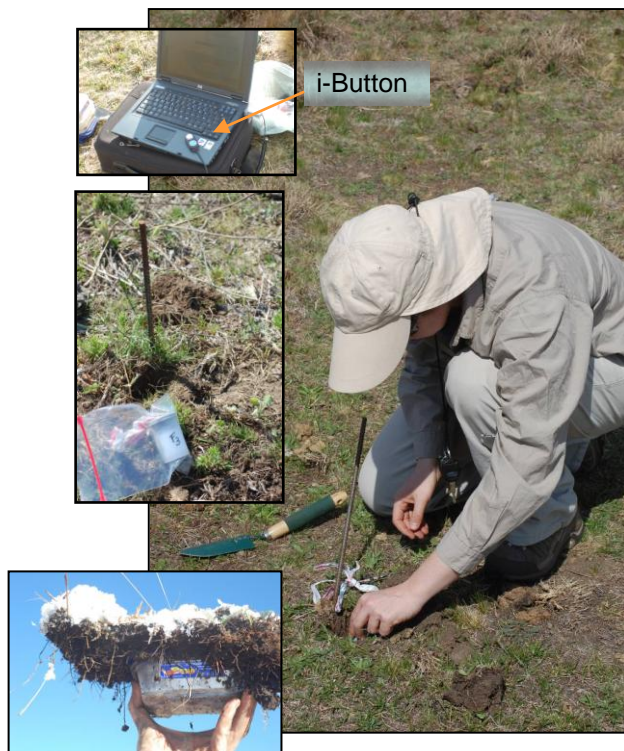
Fig. 2.4. Instrumentos de medición de la temperatura del suelo (medición diaria con frecuencia de dos horas) y de la humedad del suelo (medición mensual), en parcelas ubicadas a lo largo del gradiente altitudinal en la ladera oriental de las Sierras Grandes de Córdoba.
