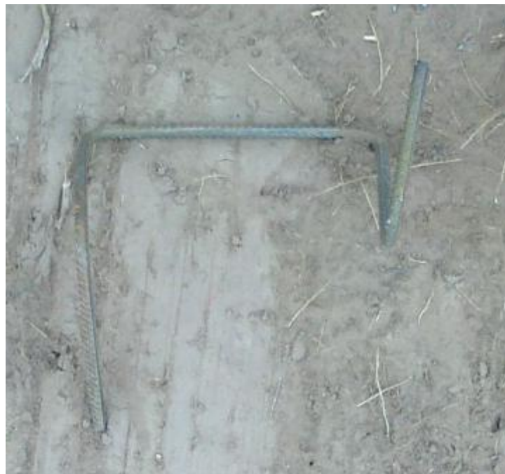
Figura 4.8: Pata de rana (separadores)
