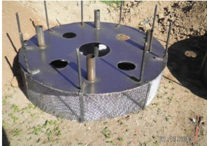
Figura 3.7. Celda de precarga para pilote de prueba
