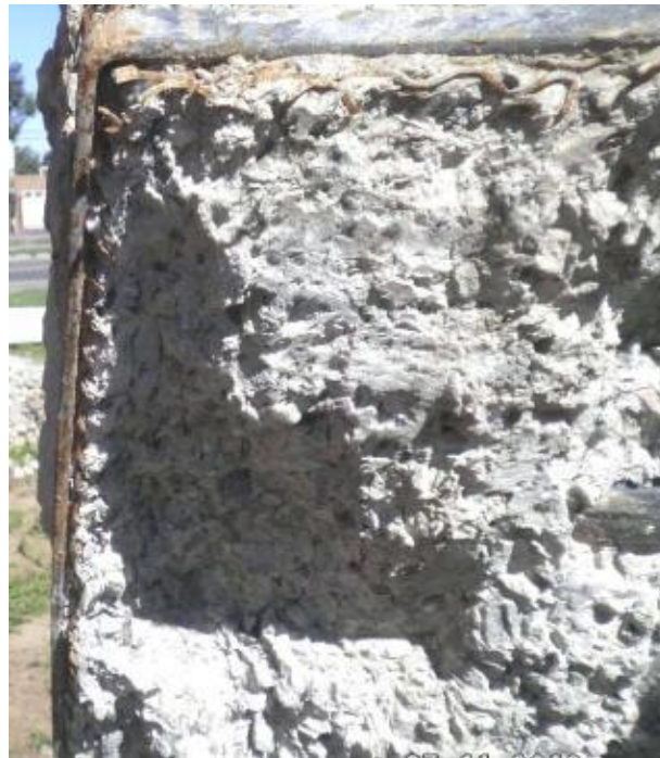
Figura 3.10. Penetración de la inyección en los áridos de la celda de precarga
