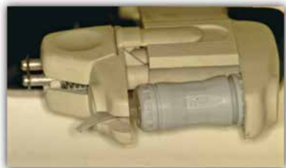
Figura 14: Mezclado por un lapso de 8 segundos a ultra alta velocidad de 6.000 rpm en Automix Computerized Mixing System Kerr Co. USA
