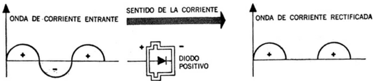
Figura 3.8. Efecto de los diodos positivos
