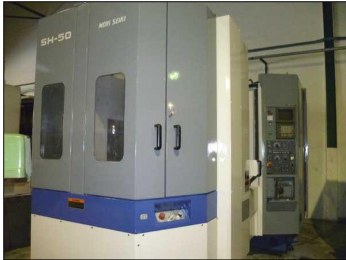
Foto 2.5: Centro de mecanizado horizontal Mori Seiki SH 50.
