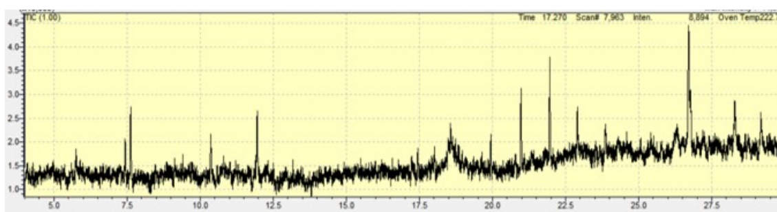
Figura A.26.: Perfil cromatográfico del líquido obtenido en la extracción con solventes de Bb . Condiciones: Hexano - 10 mL - 10 min
