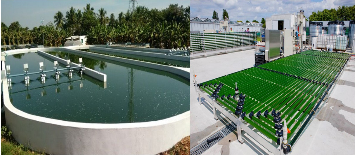
Figura 2.6.: Cultivo de algas mediante estanques abiertos y fotobiorreactores.
