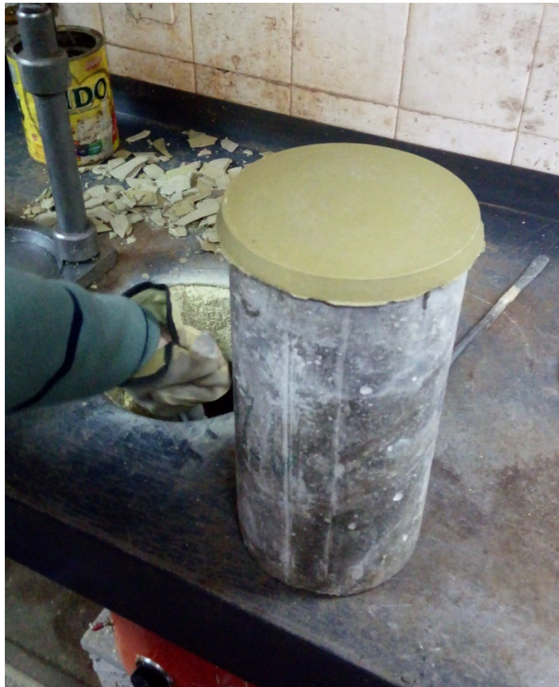
Figura 6.38: Encabezado de Mortero de Azufre. – Fuente: Elaboración Propia.
