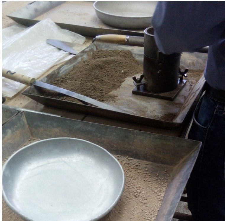
Figura 6.34: Preparación de la probeta de suelo cal. – Fuente: Elaboración Propia.
