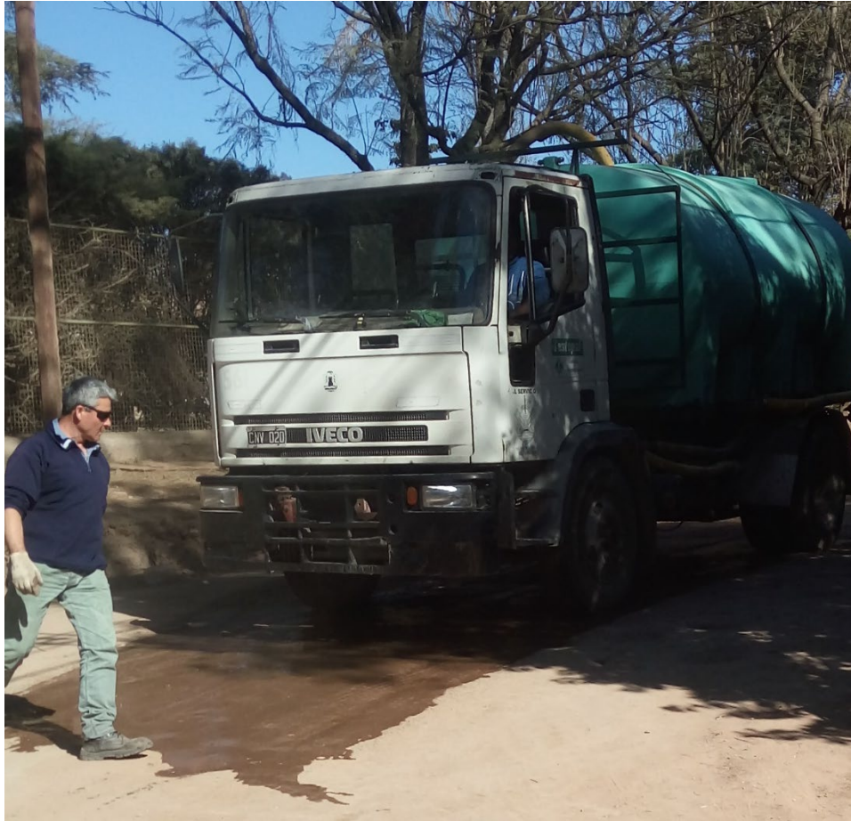
Figura 5.12. Camión Cisterna regando la superficie. – Fuente: Elaboración Propia
