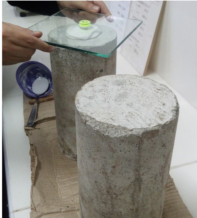
Figura 6.41: Encabezado de Yeso de Alta Resistencia. – Fuente: Elaboración Propia
