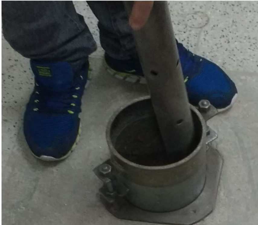
Figura 6.5: Compactado de la probeta. – Fuente: Elaboración Propia
