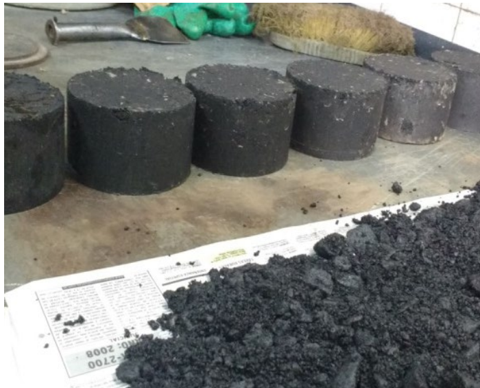
Figura 6.29: Probetas y excedente de Mezcla Asfáltica. – Fuente: Elaboración Propia.
