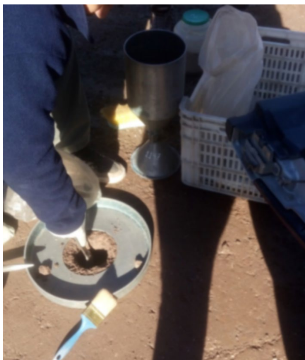
Figura 5.11: Ensayo Densidad In Situ. – Fuente: Elaboración Propia
