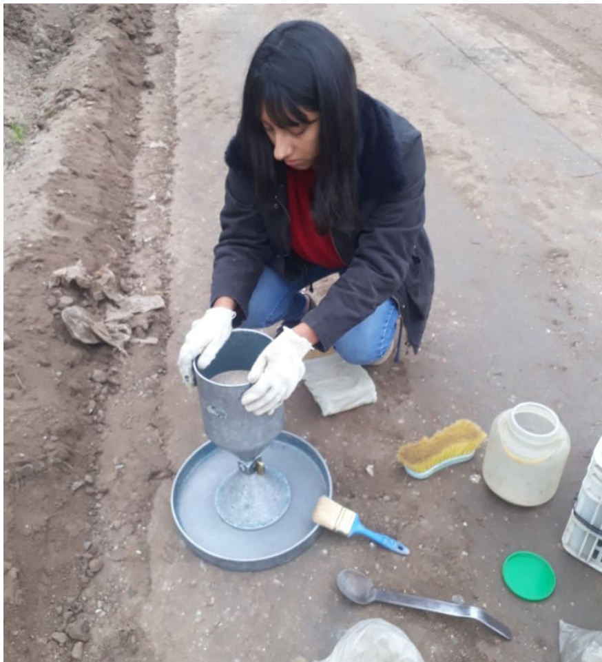
Figura 6.11: Ejecución del Ensayo de Cono de Arena. – Fuente: Elaboración Propia
