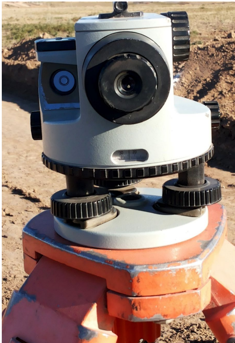
Figura 5.2: Nivel Óptico. – Fuente: Elaboración Propia.
