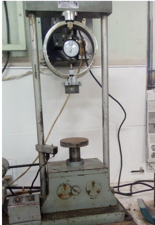
Figura 6.32: Equipo usado para medir la Estabilidad. – Fuente: Elaboración Propia.
