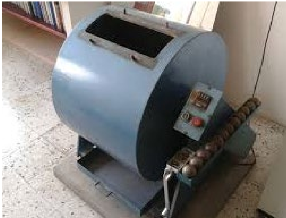
Figura 6.19: Máquina "Los Ángeles". – Fuente: Catedra de Transporte III
