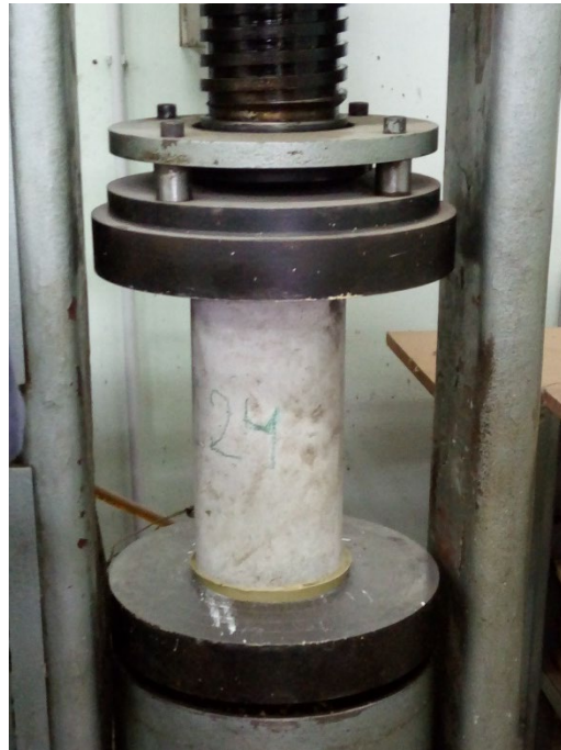
Figura 6.39: Ensayo a Compresión con encabezado de Mortero de Azufre. – Fuente: Elaboración Propia.
