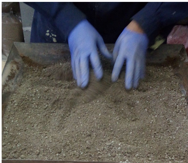
Figura 6.33: Preparación de la muestra de suelo cemento. – Fuente: Elaboración Propia.
