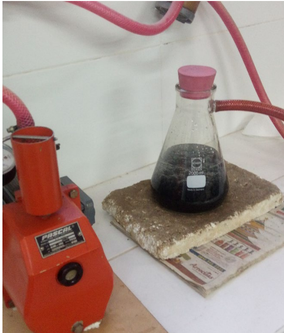
Figura 6.31: Obtención de Densidad Rice con Kitasato. – Fuente: Elaboración Propia.
