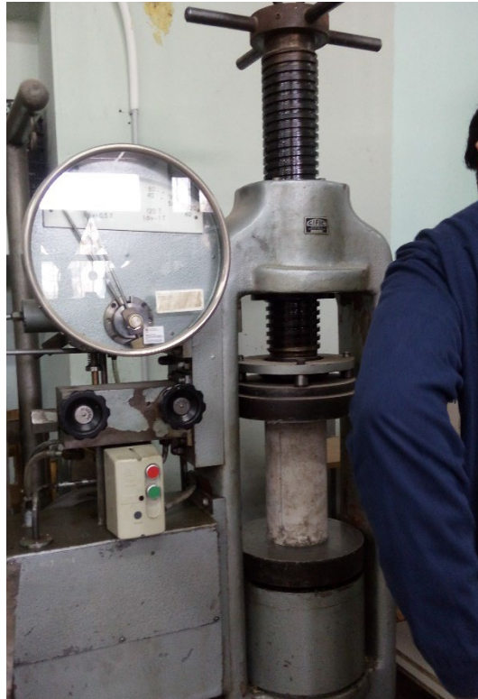
Figura 6.23: Ensayo a Compresión. – Fuente: Elaboración Propia.
