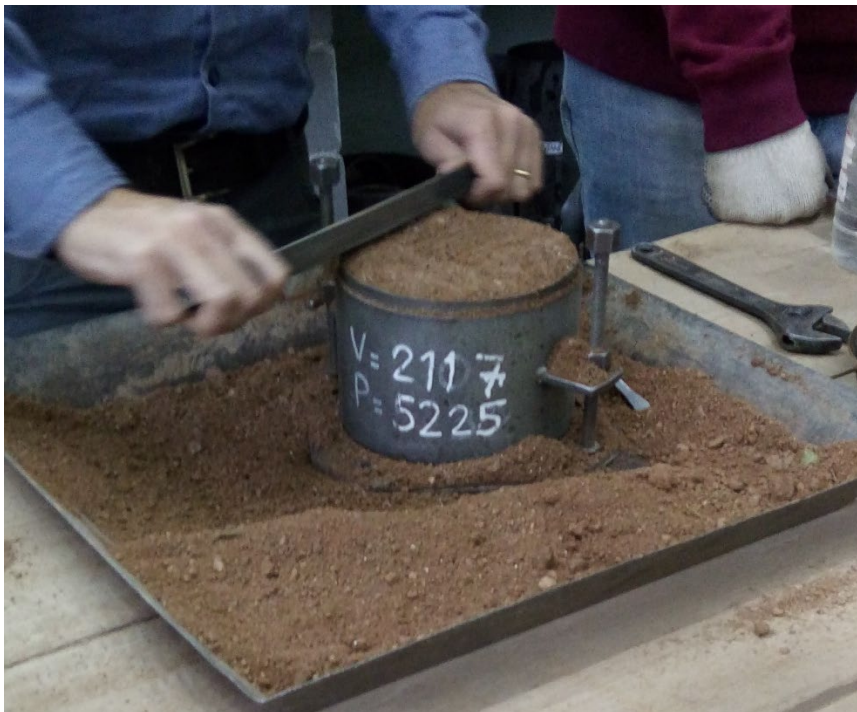
Figura 6.6: Enrasado de la probeta. – Fuente: Elaboración Propia
