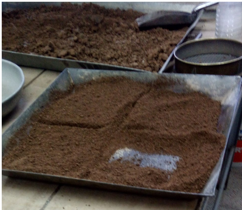
Figura 6.4: Suelo humectado en busca de la humedad óptima. – Fuente: Elaboración Propia
