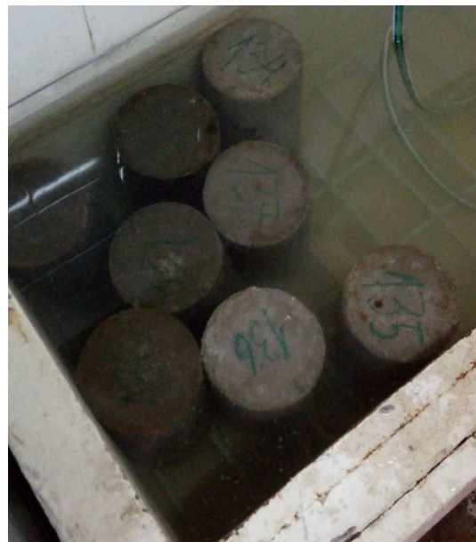
Figura 6.22: Cámara de Curado Obra. – Fuente: Elaboración Propia.
