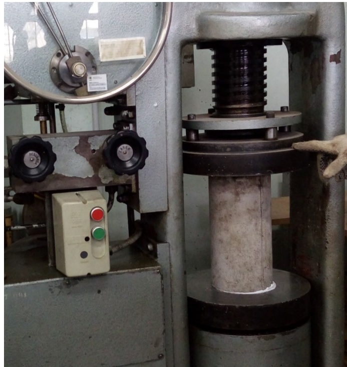
Figura 6.42: Ensayo a Compresión con encabezado de yeso. – Fuente: Elaboración Propia.
