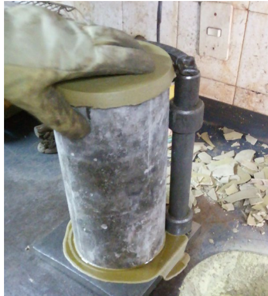
Figura 6.21: Encabezamiento de Probetas Moldeadas al pie de Obra. – Fuente: Elaboración Propia.
