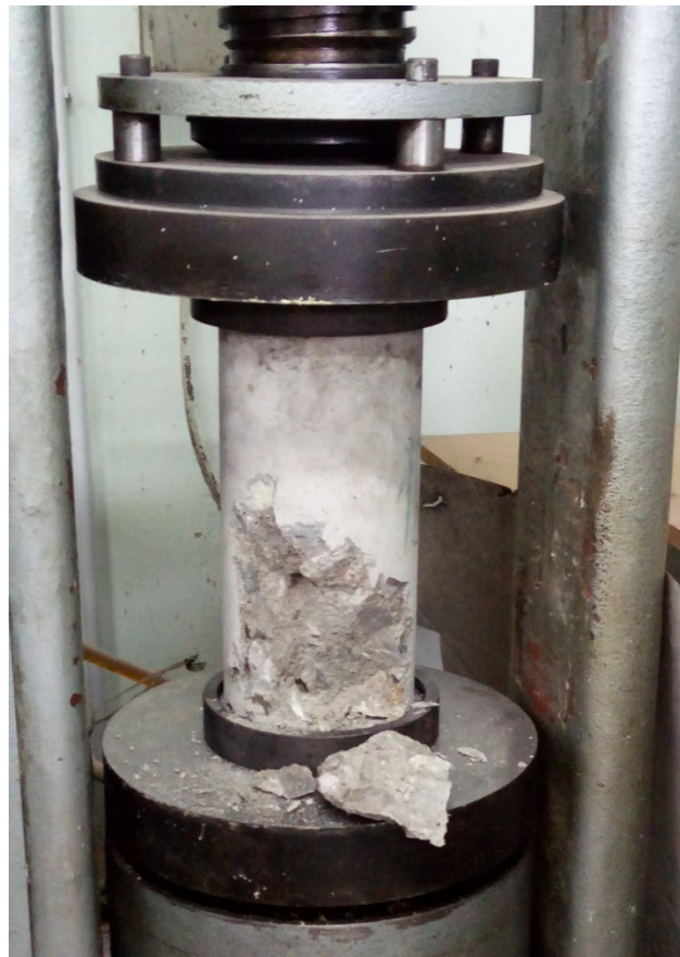
Figura 6.44: Ensayo a Compresión con encabezado de Neopreno. – Fuente: Elaboración Propia.
