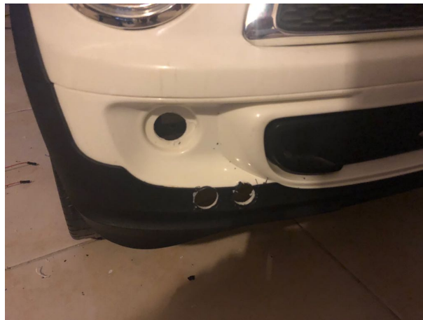
Figura 3.26: Colocación de los sensores en la estructura
