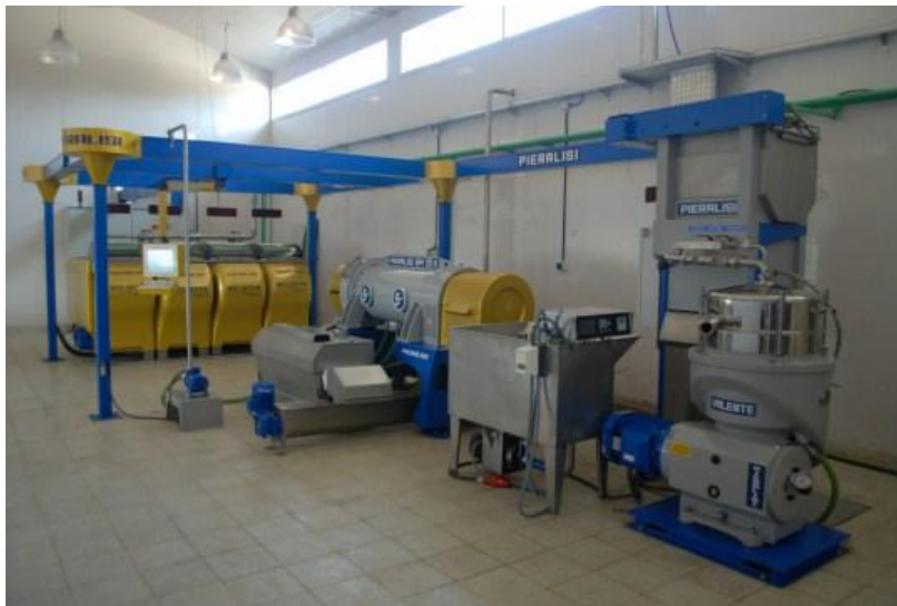
Figura 7 - Amasado, decantado y centrifugación de aceite.
