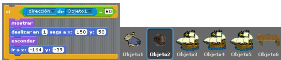
Figura 54. Uso de condicionales lógicos en la programación del Objeto 2 (bala) cuya condición se define para la dirección de 60° del Objeto 1 (cañón) (Fuente: Documento de *Scratch* producido por G7, 27/11/2014).
