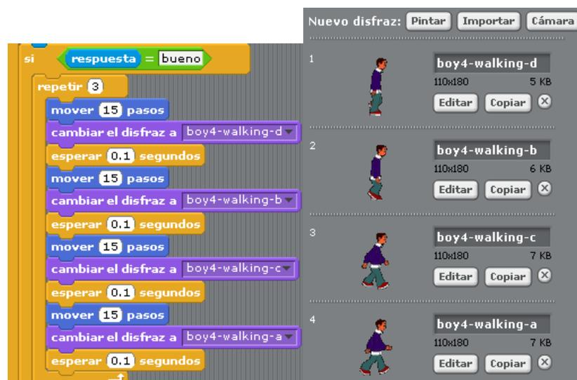
Figura 60. Secuencia de programación diseñada para simular la caminata de un personaje obtenida mediante cuatro instancias de ese movimiento (Fuente: Documento de *Scratch* producido por G10, 20/11/2014).
