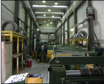
Fotos del Corte, Flejado y Pilado de las Chapas de Hierro Silicio (FeSi) para construir el Núcleo
