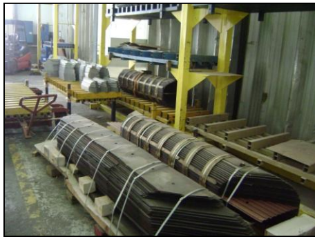
Fotos del Corte, Flejado y Pilado de las Chapas de Hierro Silicio (FeSi) para construir el Núcleo
