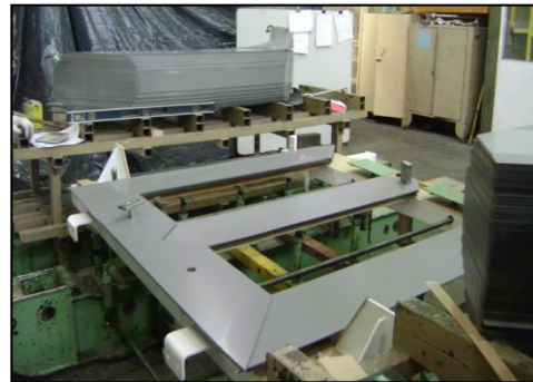
Fotos del Corte, Flejado y Pilado de las Chapas de Hierro Silicio (FeSi) para construir el Núcleo
