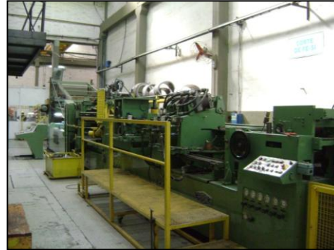
Fotos del Corte, Flejado y Pilado de las Chapas de Hierro Silicio (FeSi) para construir el Núcleo
