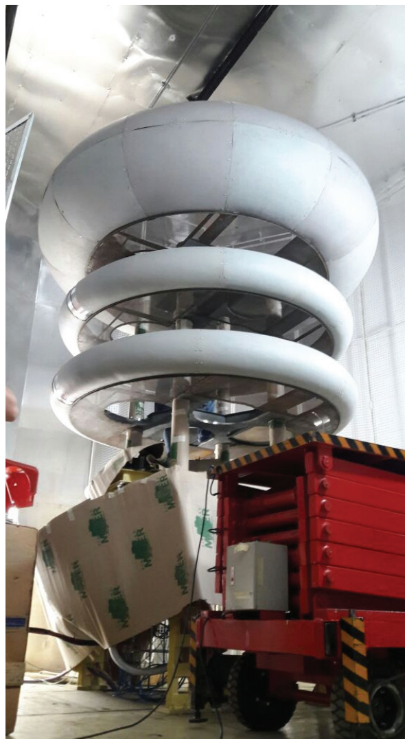
Fig. 42: Nuevo acelerador de 720kV.
