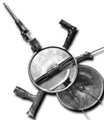
Fig. 9: Primer ciclotrón construido por Ernest Lawrence en 1930. Tenía 13 cm de diámetro y aceleraba protones hasta 80 keV. (LBNL).
