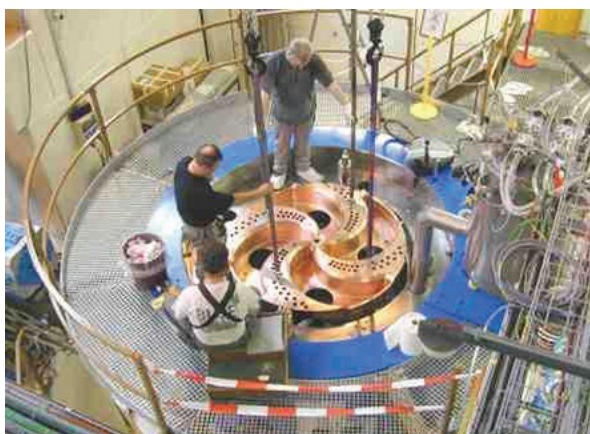
Fig. 12: Ciclotrón superconductor en el Paul Scherrer Institute, protones de 250 MeV.
