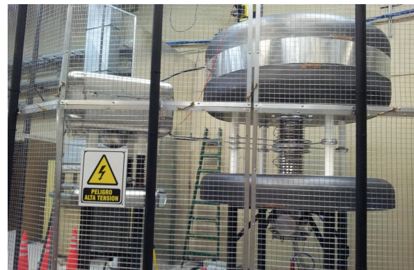
Fig. 34: Acelerador de 200 kV montado dentro de la jaula de Faraday.
