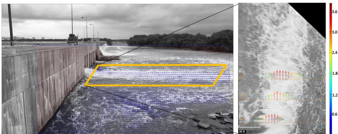
Figura 63 - Campo de Velocidad detectado con LSPIV y perfiles de velocidad media superficial [m/s] en descargador de fondo de la presa de Brandon Road.
