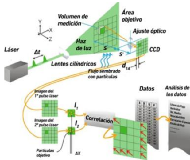
Figura 2 - Esquema del conjunto de elementos para la aplicación de PIV clásico.
