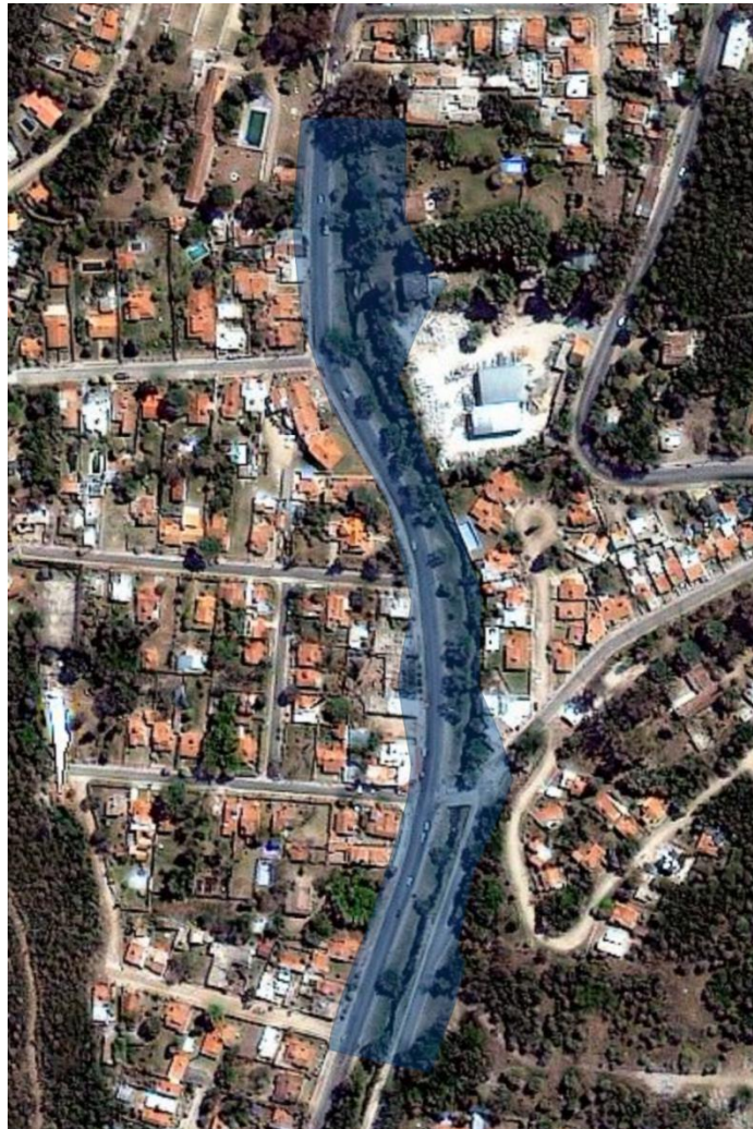
Figura 30 - Áreas inundadas obtenidas a partir de la simulación numérica realizada para un caudal de 290 \text{ m}^3/\text{s} .
