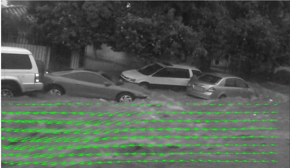
Figura 45 – Campo medio de vectores desplazamiento no rectificadas obtenidos de la implementación de LSPIV. Las flechas representan los vectores velocidad superficial del agua.
