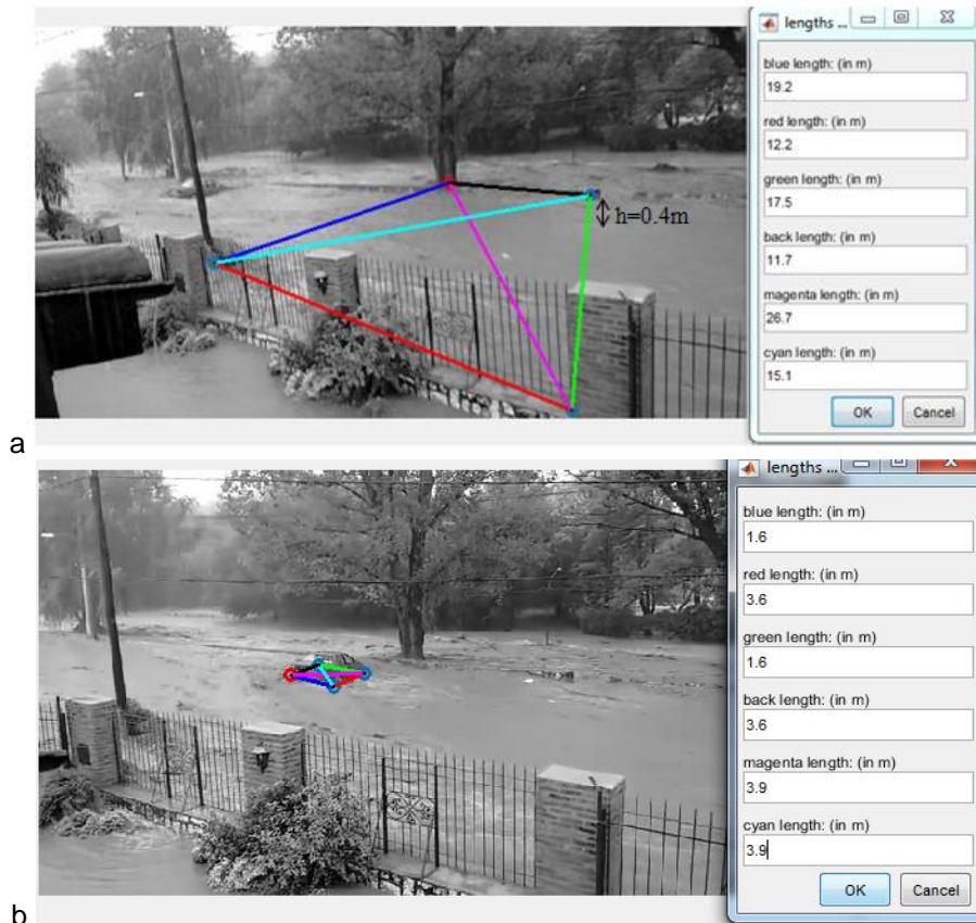
Figura 55 – (a) Puntos de control fijos relevados luego del evento de inundación. (b) Puntos de control móviles estimados teniendo en cuenta las dimensiones del vehículo.
