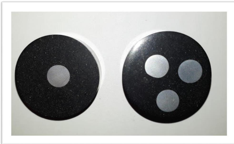
Figura 5. Molde para ensayo metalográfico.
