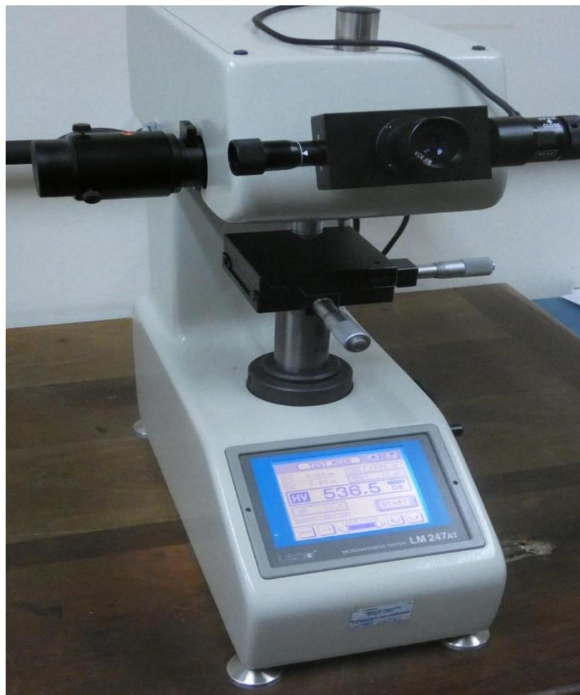
Figura 6. Microdurómetro marca LECO modelo LM-247-AT.
