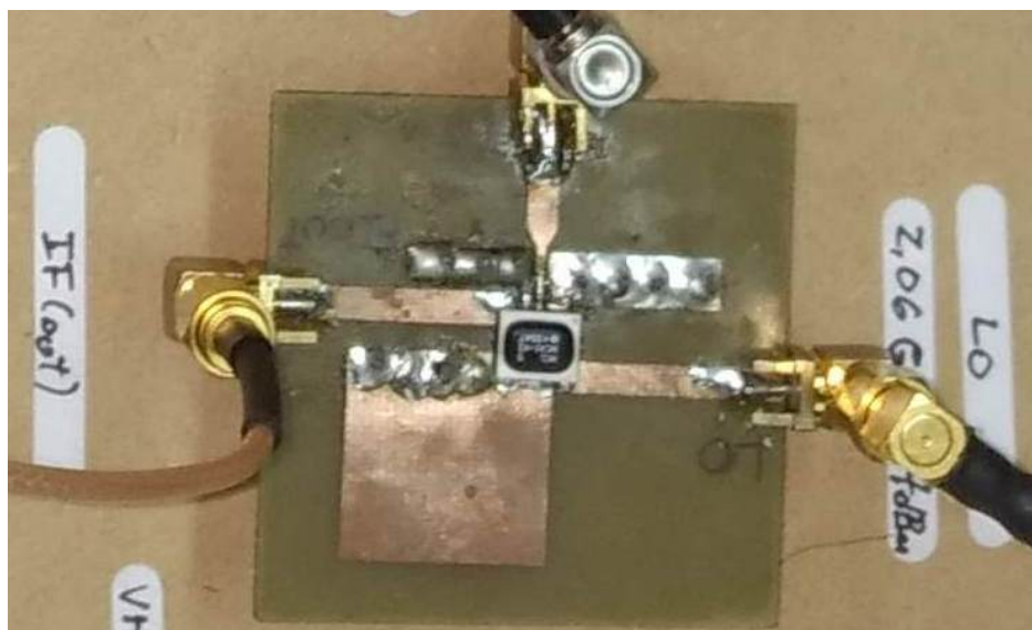
Figura 9.19: Mezclador en UHF implementado. Fuente: propia.
