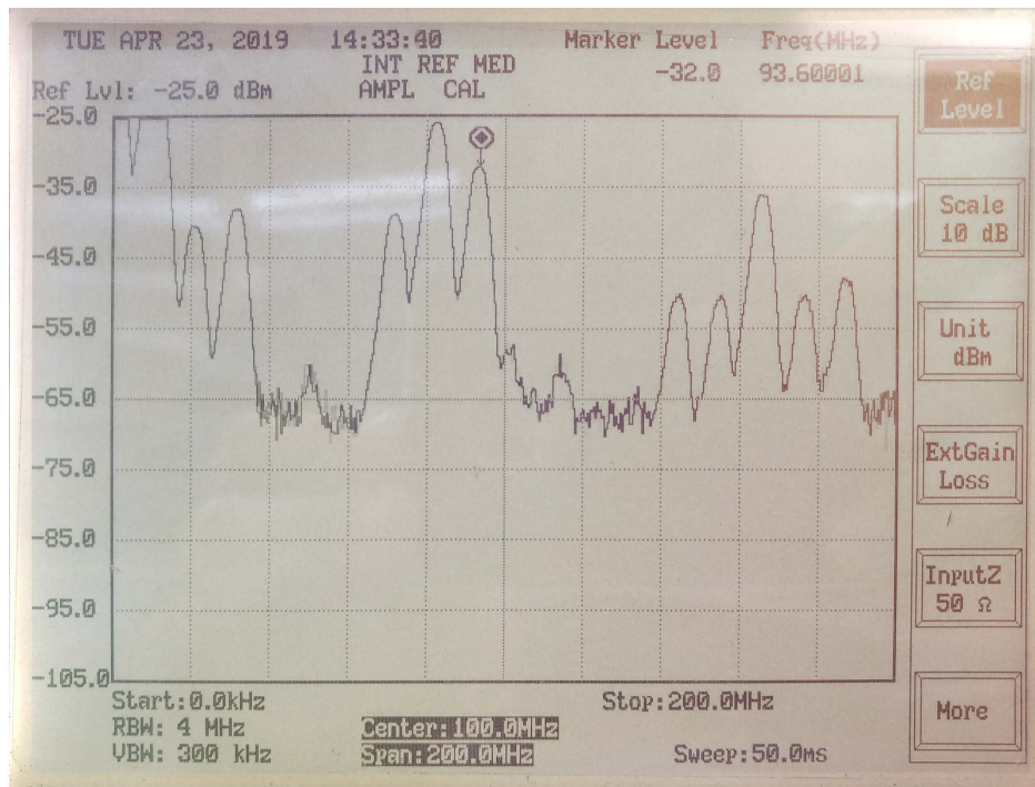
Figura 7.22: Salida mezclador VHF - Ref Level = -25 dBm. Fuente: propia.
