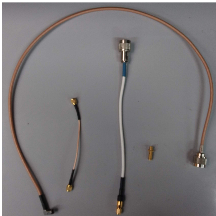
Figura 6.4: Cables utilizados para la conexión de etapas y para las mediciones. Fuente: propia.
