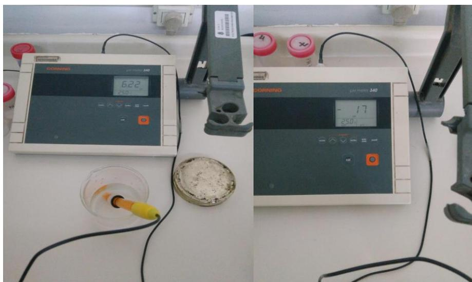
Figura 15: PH y conductividad eléctrica (Mv) de la Solución Final (S2).
