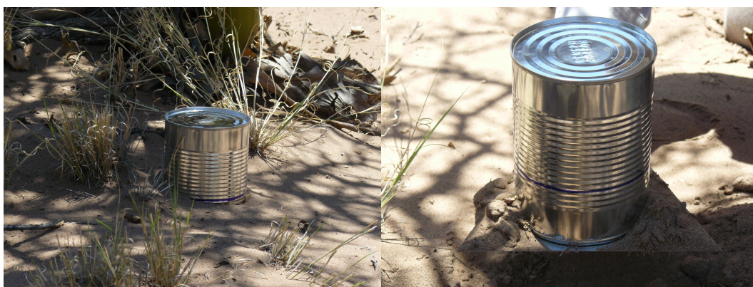
Figura 2.3. Sacabocados con los que se extrajeron las muestras de suelo en cada micrositio.
